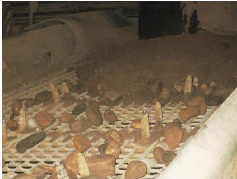
Рисунок 4.3. Процесс фракционирования сыпучей смеси на верхнем сите грохота СМД-121
