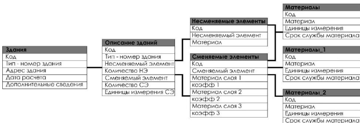
Рисунок 15. Схема данных энергоёмкости строительных материалов на основании реляционной модели
