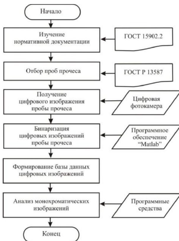
Рис. 6.5 – Блок-схема алгоритма бинаризации цифрового изображения пробы прочеса
