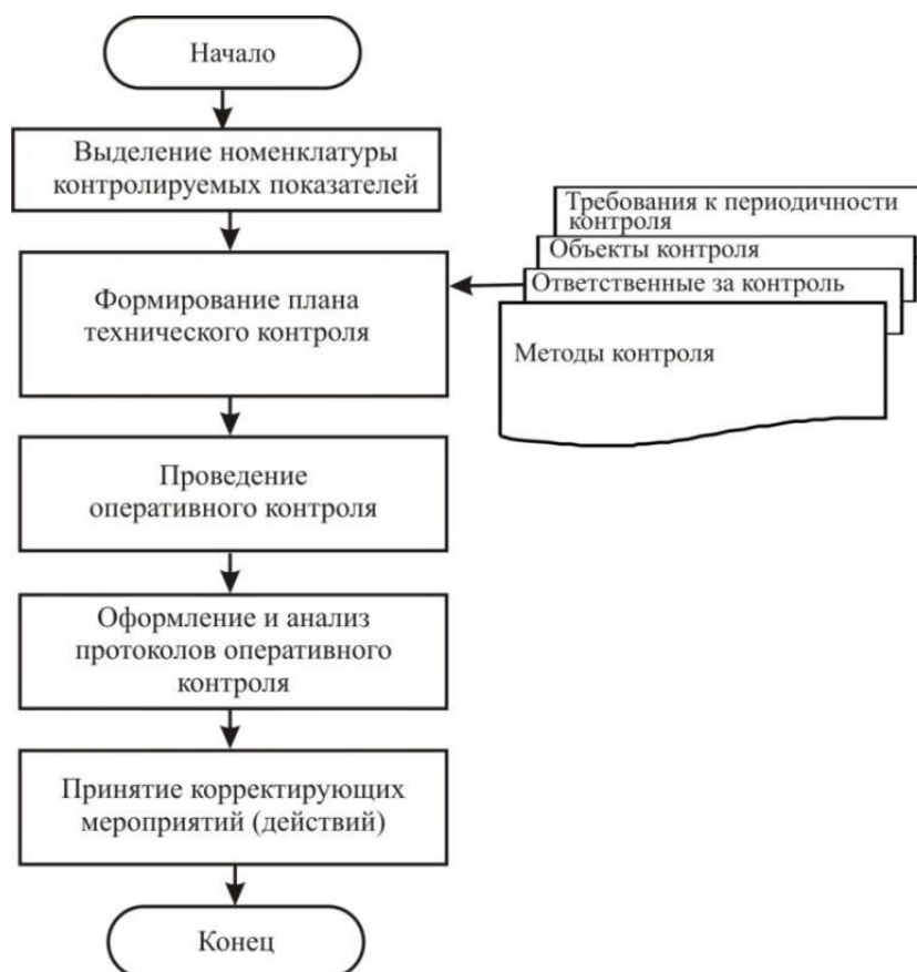
Рис. 1.3 – Блок-схема алгоритма проведения операций технологического контроля на предприятиях по производству текстильной и геотекстильной продукции [53]
