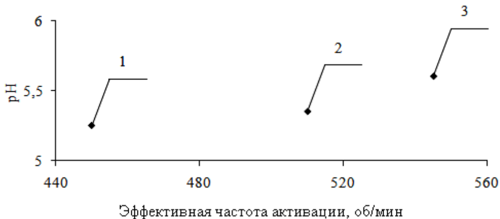
Рисунок 5.17 Номограмма механоактивационной эффективности роторных насадок: 1 - конфузор-диффузор; 2 – конфузор; 3 – пропеллер
