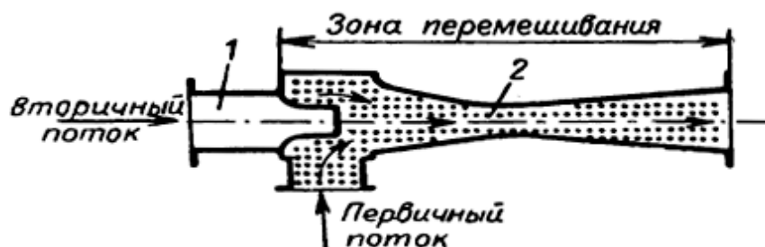
Рисунок 1.7 Конструкция инжекторного перемешивающего устройства: 1- сопло; 2- диффузор
