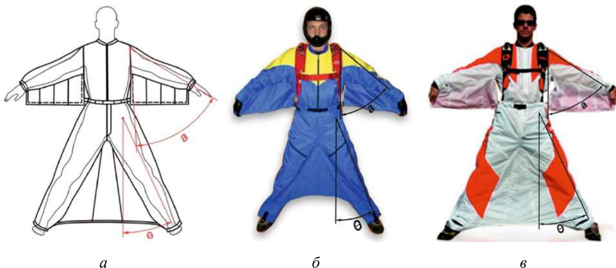
Рисунок 2.2 – Угловые биомеханические показатели положения верхних и нижних конечностей: a - схема измерения; б, в - примеры измерения на моделях «Продиджи - 1» ( \alpha - 52^\circ , \theta - 21^\circ ) и «Продиджи - 2» ( \alpha - 57^\circ , \theta - 25^\circ ) фирмы Phoenix-Fly (Хорватия)
