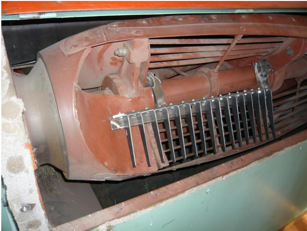
Рис. 4.13. Параллелизующий узел, установленный на барабане МТА-2Л.
