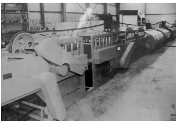
Рис. 1.16. Мьяльно-трепальный агрегат фирмы «Юнион»
