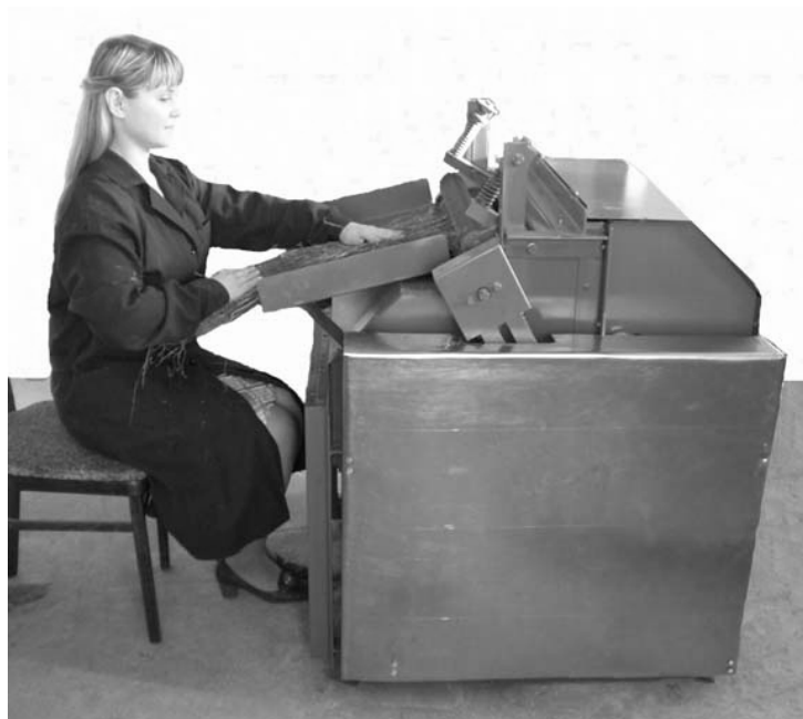
Рис. 1.12. Однопроцессная машина для обработки льна
