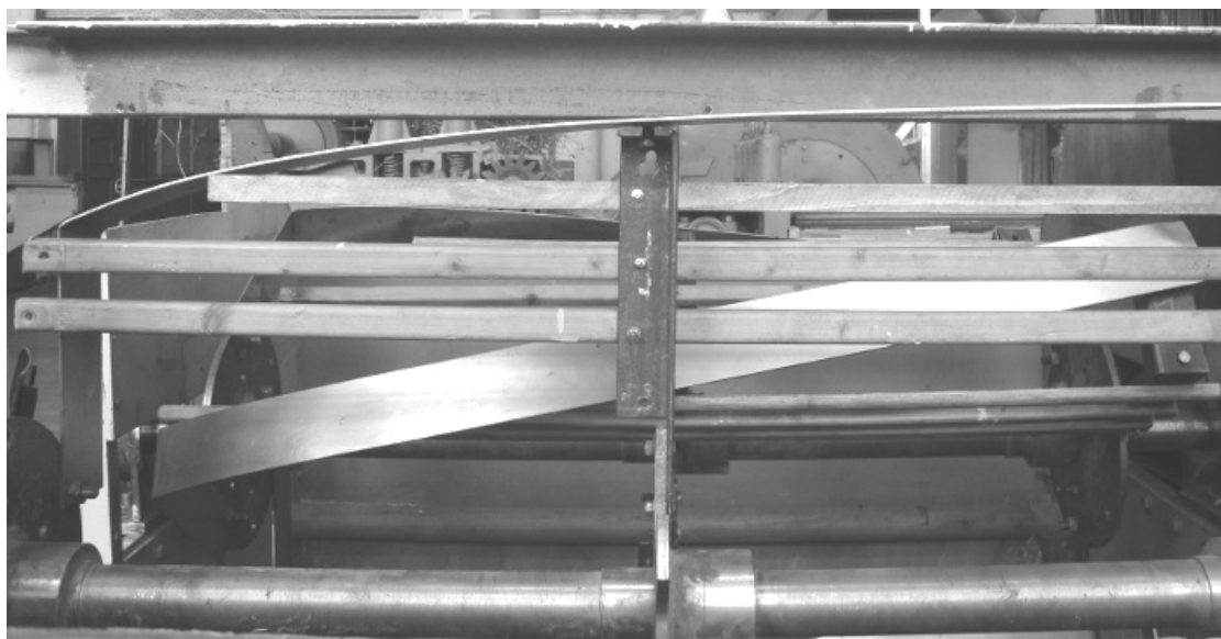
Рис. 4.1. Внешний вид экспериментального трепального станка (а) и барабанов новой конструкции (б)
