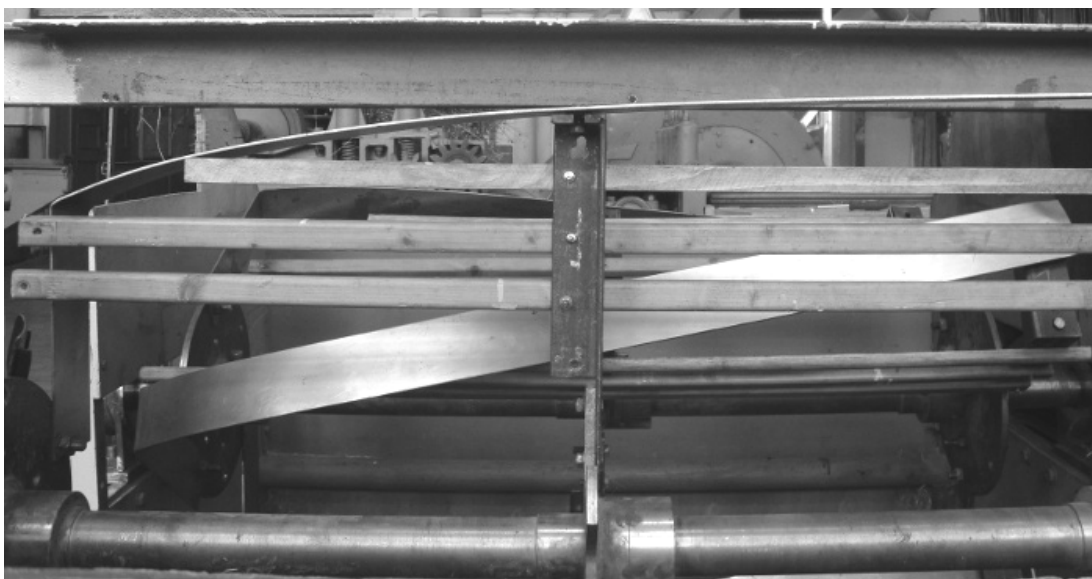
Рис. 3.6. Форма бильных планок, использованных в эксперименте
