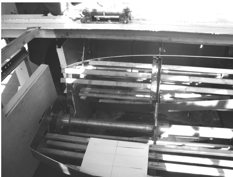
Рис. 3.7. Расположение листа бумаги для отпечатков ленты на подбильной решетке била трепального барабана
