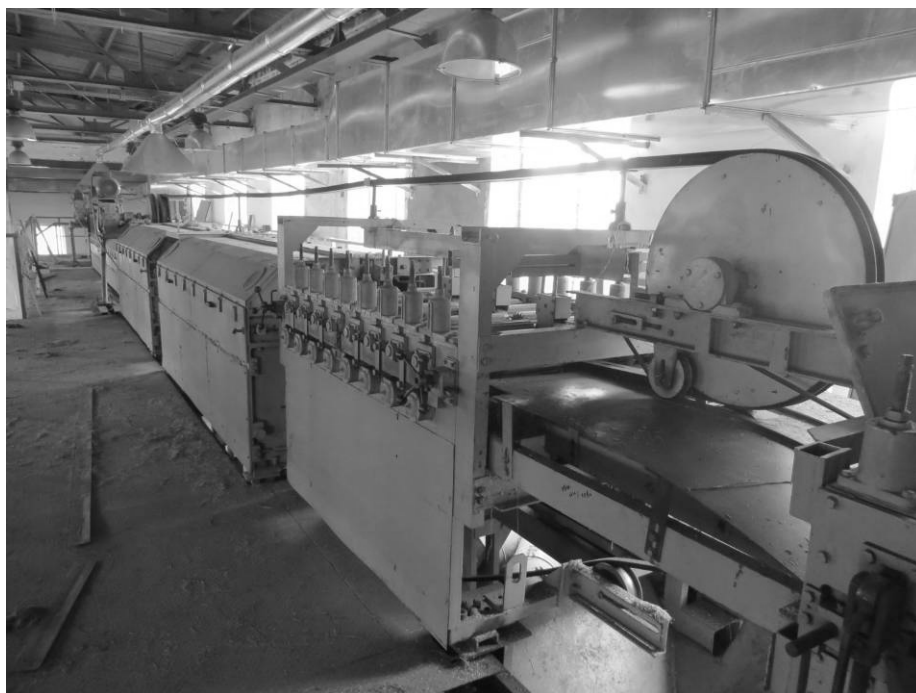
Рис. 1.9. Новый мяльно-трепальный агрегат МТА-3Л в цеху Даниловского льнозавода (вид: начиная с последней секции мяльной машины и четырёхсекционная трепальная машина)
