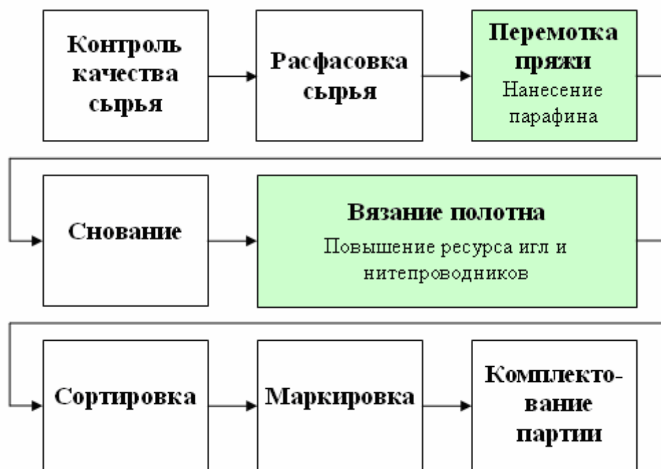
Рис. 5 - Технологические переходы производства трикотажного полотна
