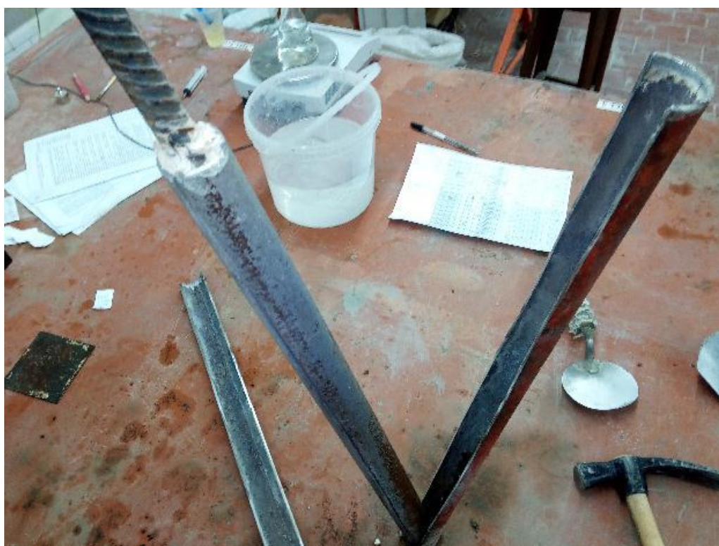
Рис. 5.12. Внешний вид разрезанной модели штепсельного стыка.
