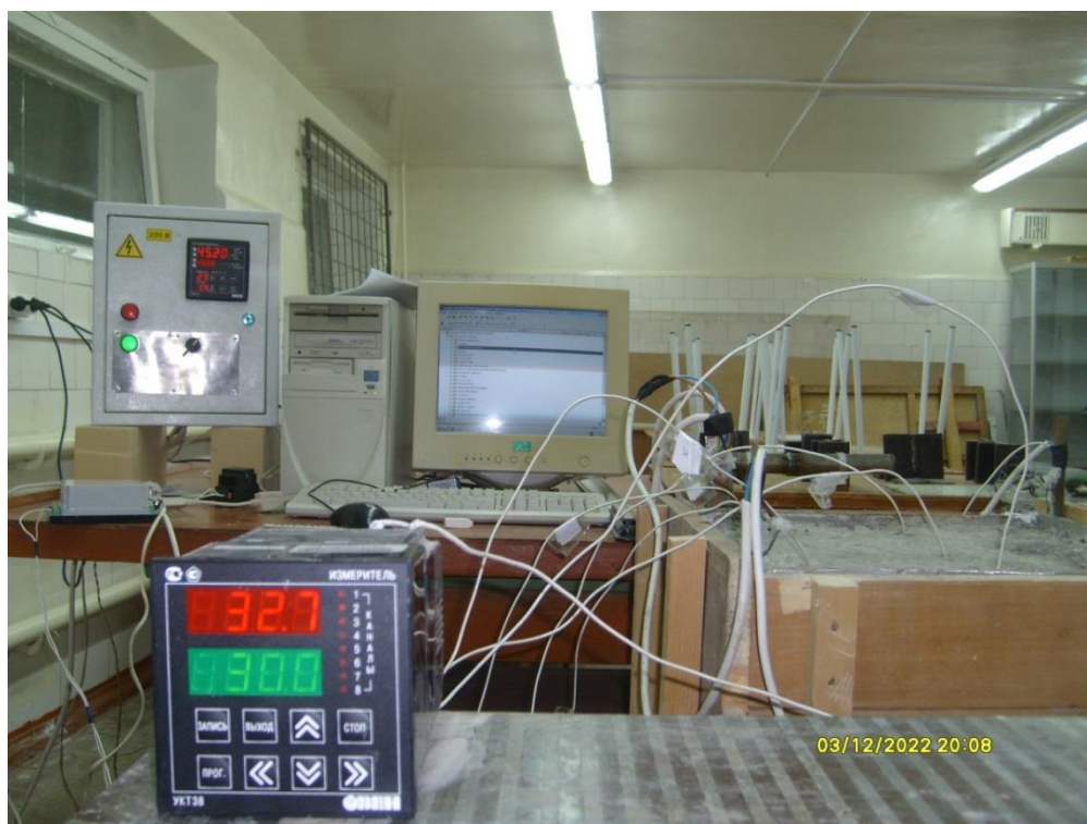
Рис. 5.5. Внешний вид автоматизированной установки для электротепловой обработки железобетонных изделий с помощью поверхностного электропрогрева
