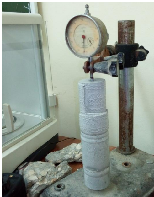
Рис. 4.12. Устройство для определения усадки бетона
