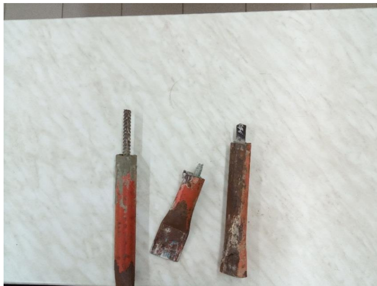
Рис. 4.18. Образцы-модели штепсельного стыка для определения механической прочности
