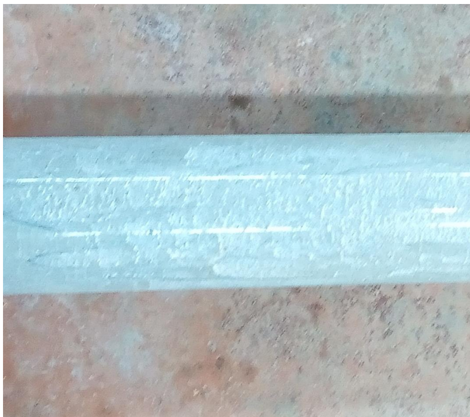
Рис. 5.13. Внешний вид контактной поверхности бетонной смеси.
