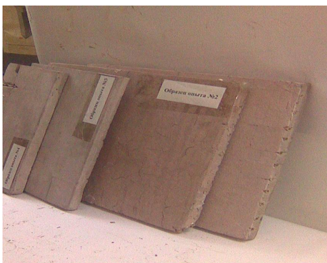
Рис. 7.3. Облицовочные плитки из серосодержащего арболита
