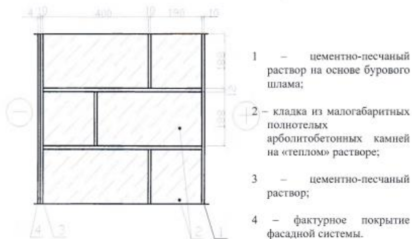
Рисунок 8.4 – Конструкция наружной стены
