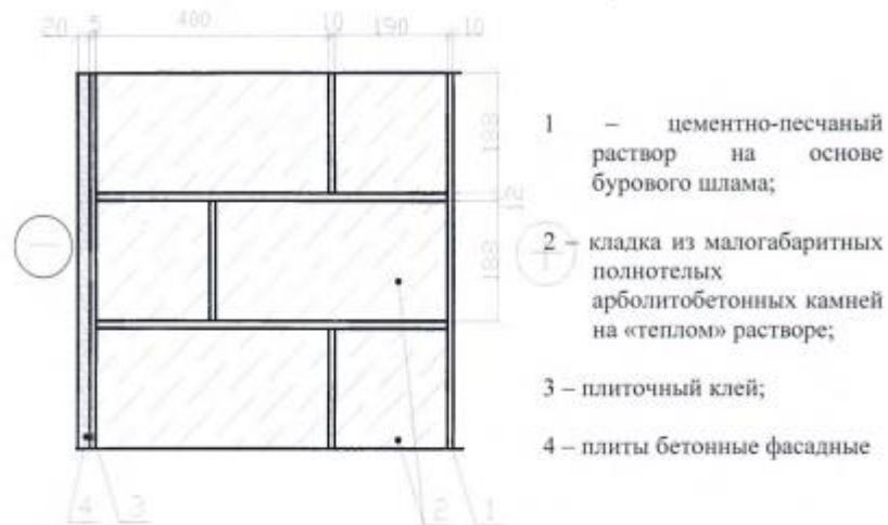
Рисунок 8.6 – Конструкция наружной стены
