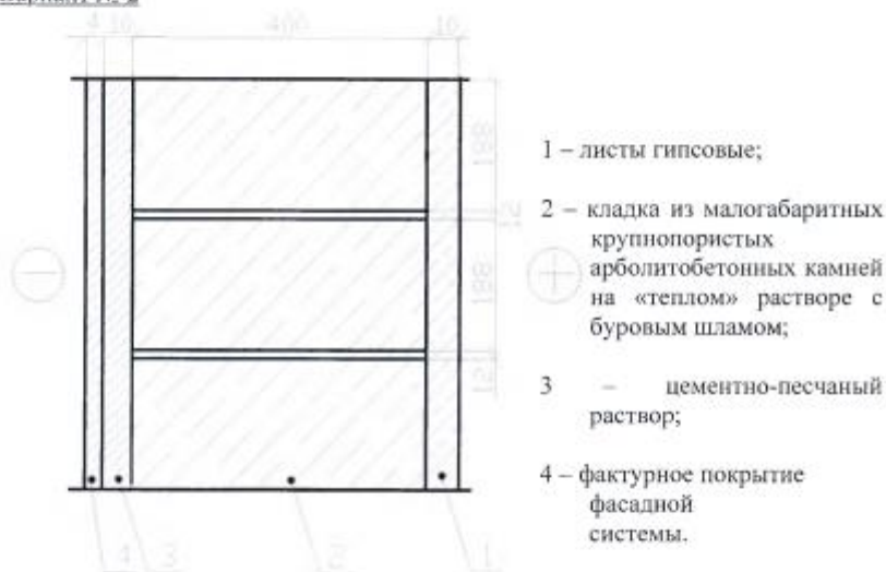
Рисунок 8.2 – Конструкция наружной стены
