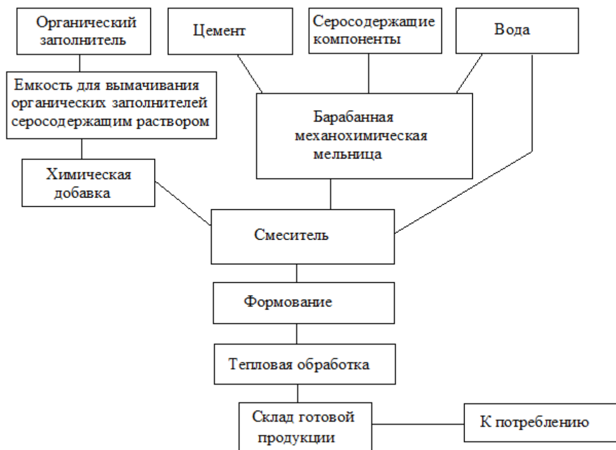
Рис. 5.9. Принципиальная технологическая схема производства серосодержащего арболита
