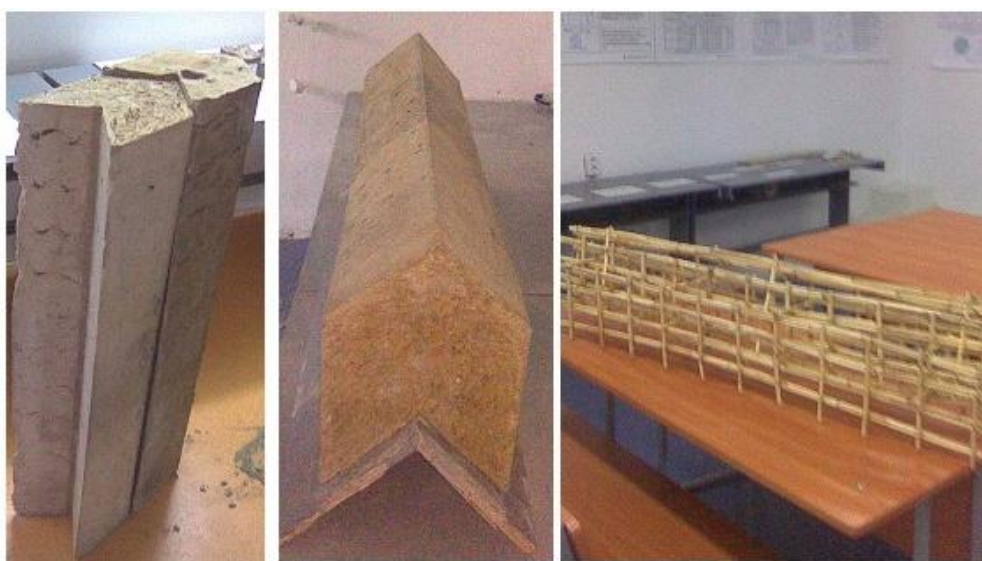
Рис. 7.4. Образцы вертикальных серосодержащих арболитовых брусков
