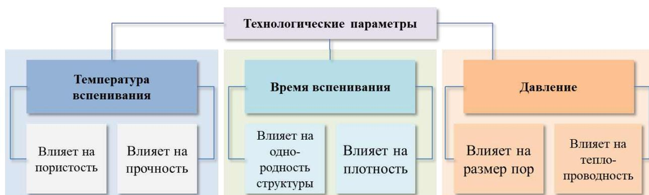
Рисунок 1.1 – Технологические параметры производства пеностекла
