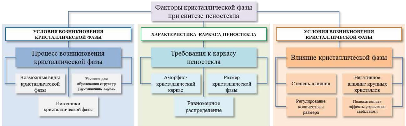
Рисунок 1.17 – Факторы процесса кристаллизации
