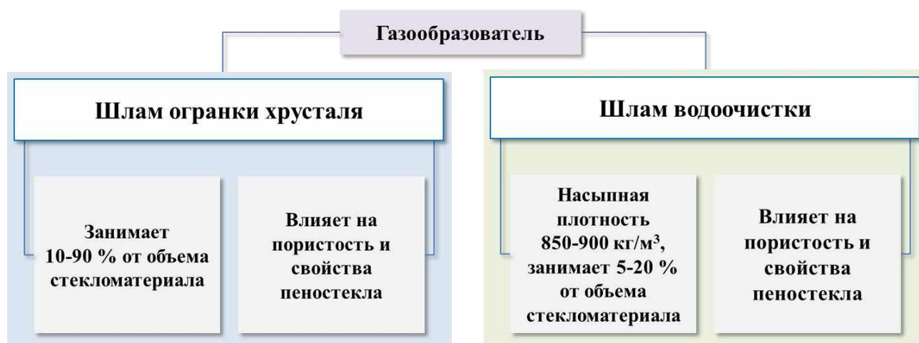
Рисунок 1.2 – Вариации использования отходов в качестве газообразователя
