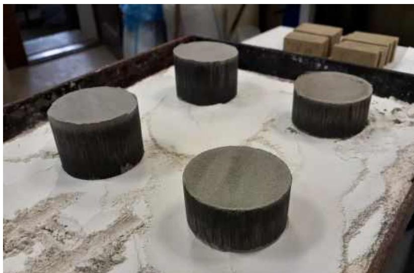
Рисунок 2.6 – Образцы пеностекла серии 1, подготовленные к тепловой обработке
