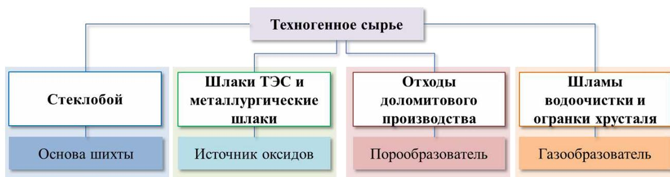
Рисунок 1.4 – Основные принципы использования техногенного сырья в производстве пеностекла
