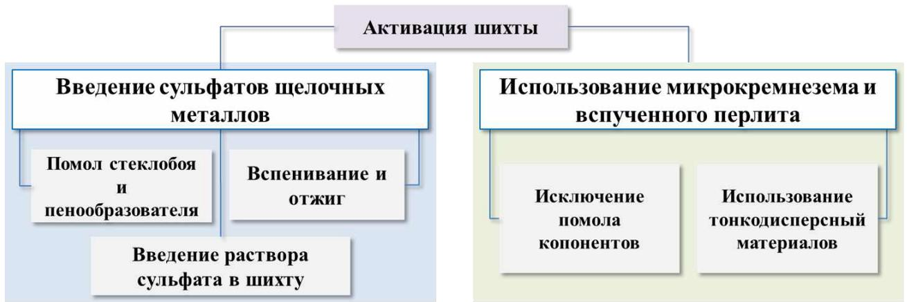
Рисунок 1.3 – Механизмы активации шихты при производстве пеностекла
