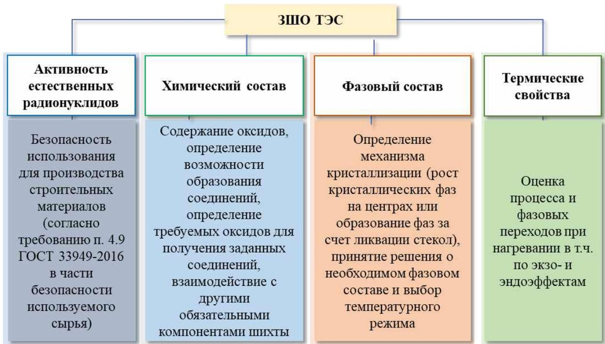
Рисунок 2.1 – Инструментальный анализ ЗПО ТЭС
