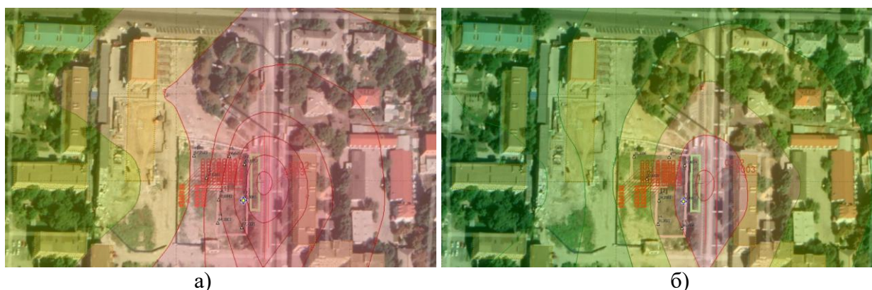
Рисунок 17 — Шумовая карта объекта строительства: (а) без использования пеностекла; (б) с использованием пеностекла
