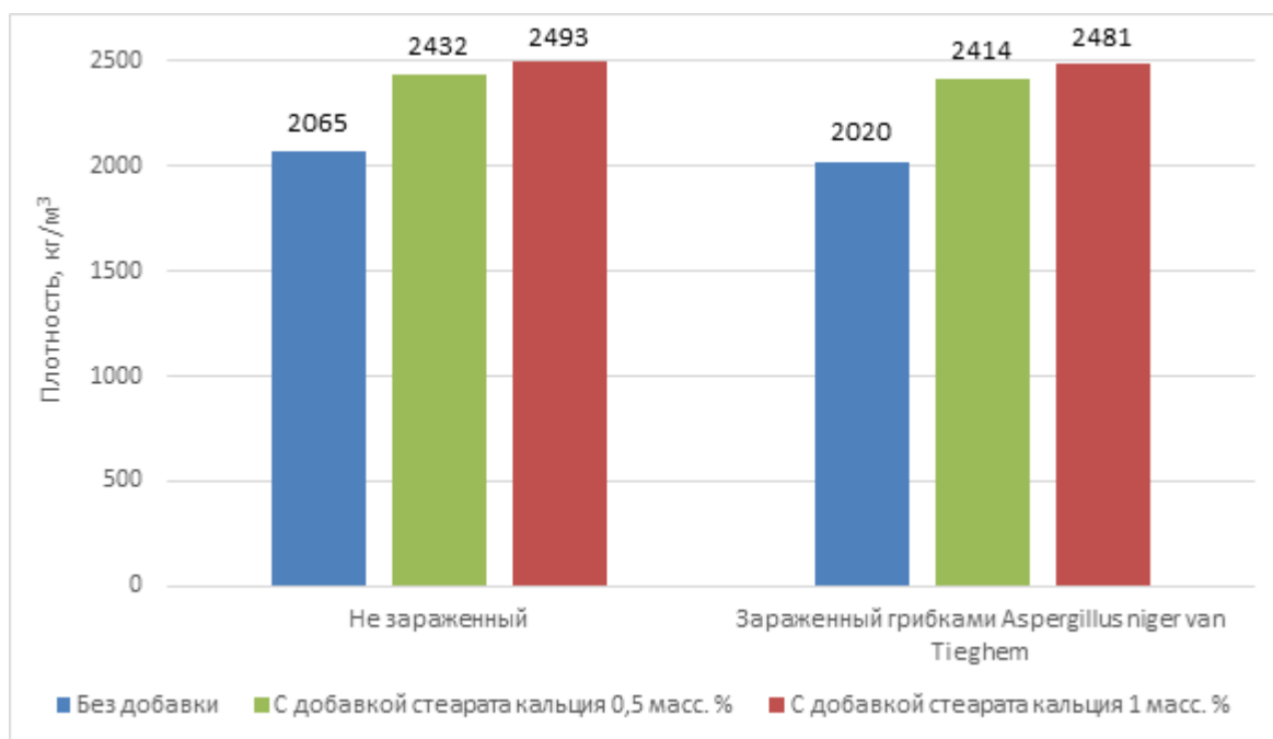
Рис. 3.2. Изменение плотности бетона после 12 месяцев грибковой коррозии
