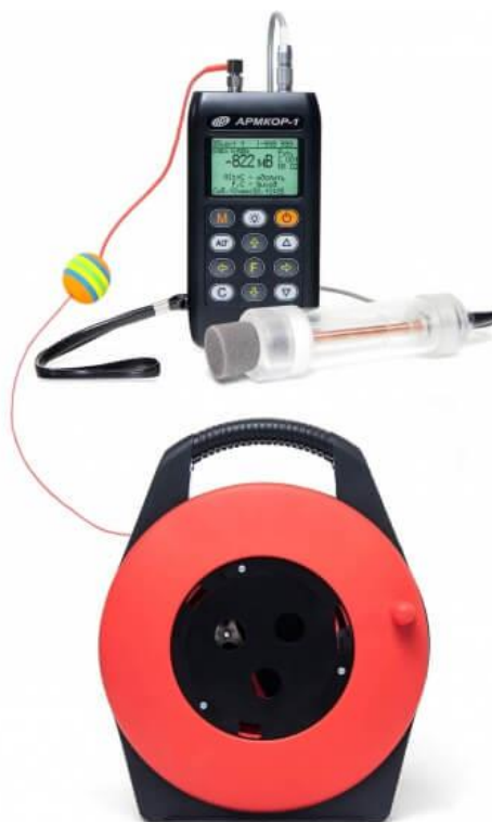
Рис. 2.14. Анализатор коррозии стальной арматуры АРМКОР-1
