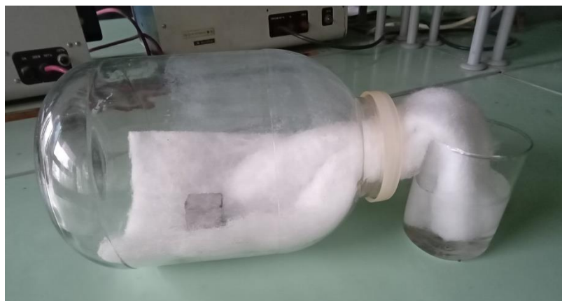
Рис. 2.7. Емкость для создания условий воздействия на образцы капиллярного смачивания
