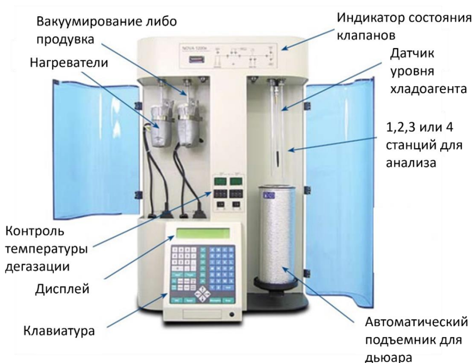
Рис. 2.10. Автоматический анализатор удельной поверхности и размера пор NOVA Series 1200e
