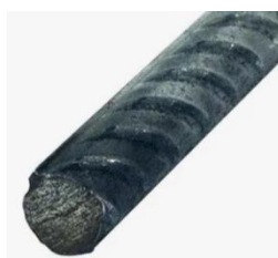
Рис. 2.3. Профиль стальной арматуры класса А500С, используемой в исследовании
