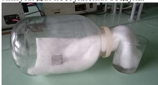
Рис. 2. Емкость для создания условий воздействия на образцы капиллярного смачивания
