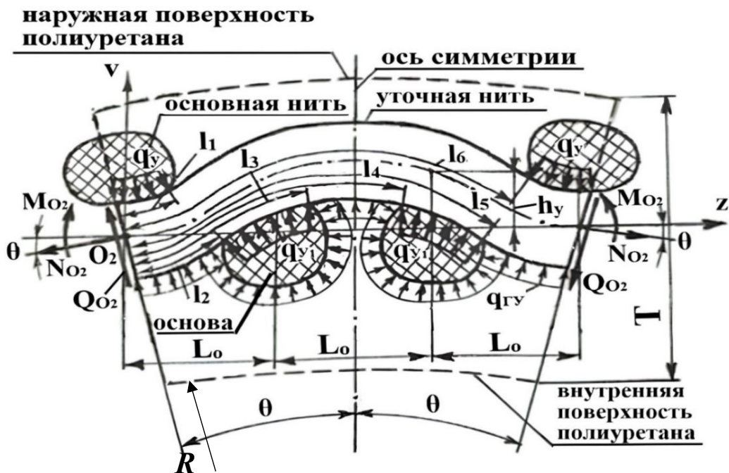
Рисунок 2.4 - Расчетная схема равновесия отрезков основной (а) и уточной (б) нитей АТО
