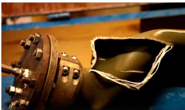
Рисунок 3.7 - Разрушение ПГР от разрыва уточных нитей
