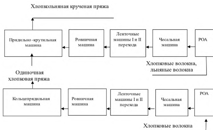
Рис. 4.3. Схема технологического процесса получения хлопкольнайной
