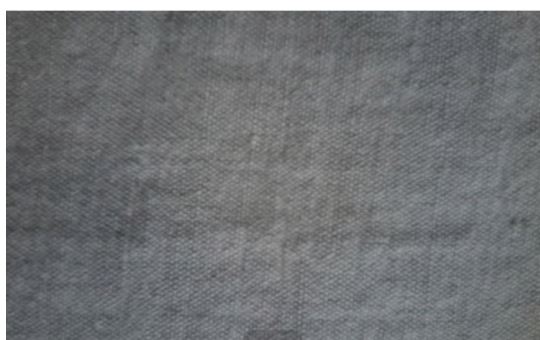
Рис. 4.7. Ткань портьерная комбинированного переплетения
