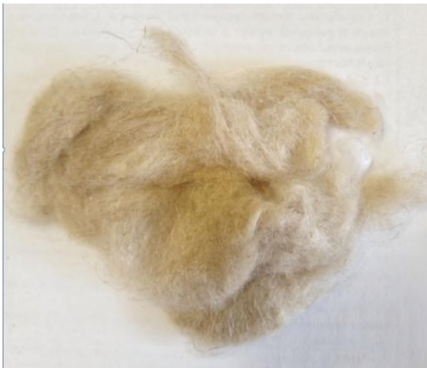
Рис. 3.2. Льняные волокна на выходе из технологической линии для получения одиночных льняных волокон из котонина
