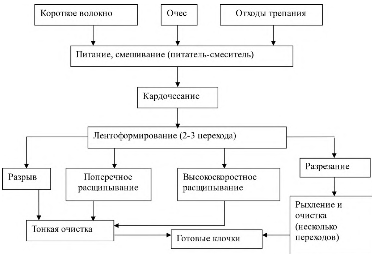
Рис. 1.1. Схема получения котонина по механической технологии
