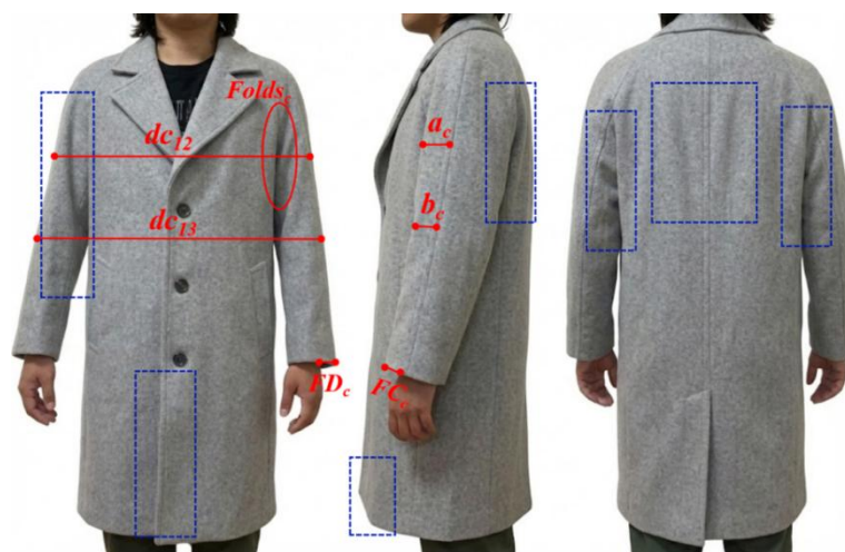
Рисунок 5.7 - Фотоанализ пальто с рукавом реглан: синие пунктирные линии выделяют локальные дефекты; красные сплошные линии показывают места измерений
