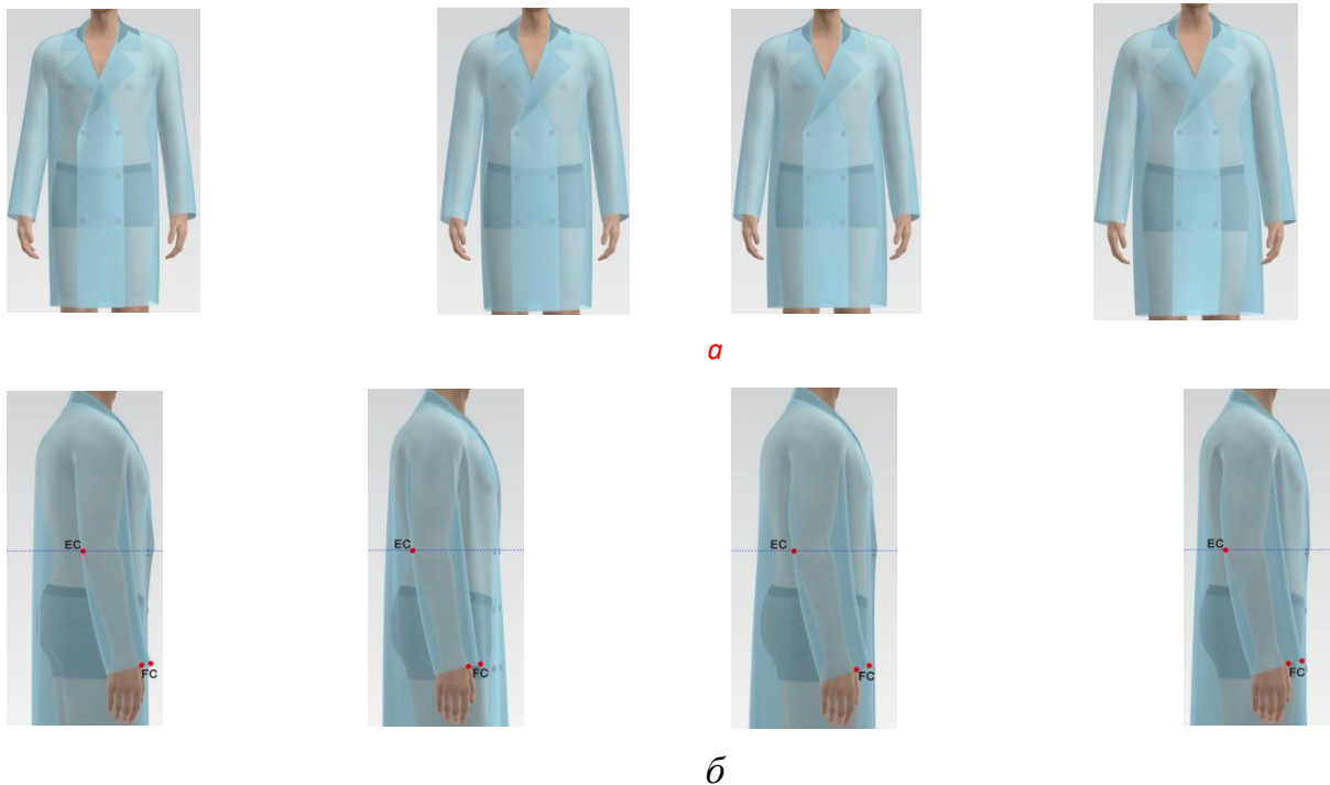
Рисунок 2.13 - Определение воздушного зазора в локтевой точке ЕС при различных значениях ECG = 12, 16, 20 и 24 см: а – фронтальные виды при ECG слева направо; б – профильные виды при ECG слева направо.
