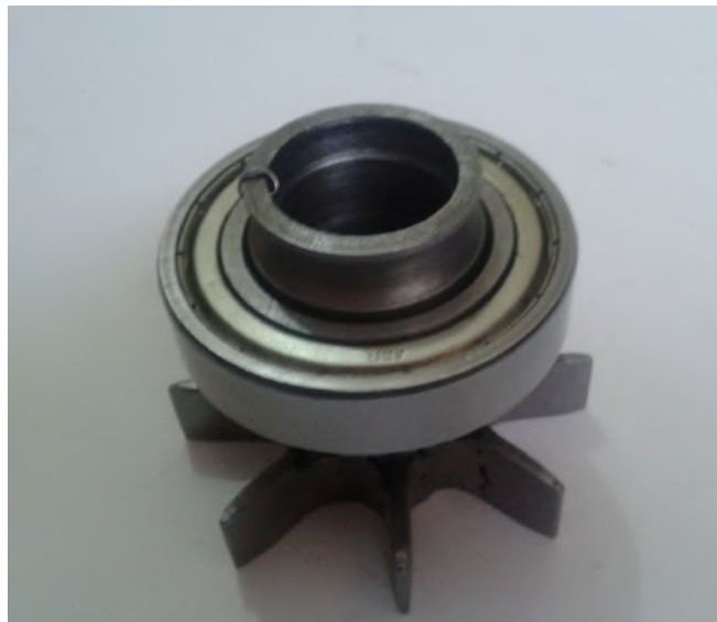
Рисунок 4.2. Конструкция подшипника на втулке с лопастями
