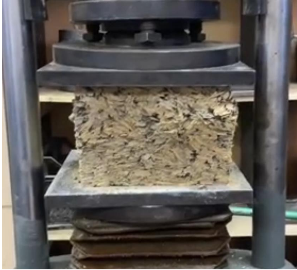
Рис. 4.20. Испытание образца куба размером с гранью 15 см на сжатие (вид образца после испытаний)
