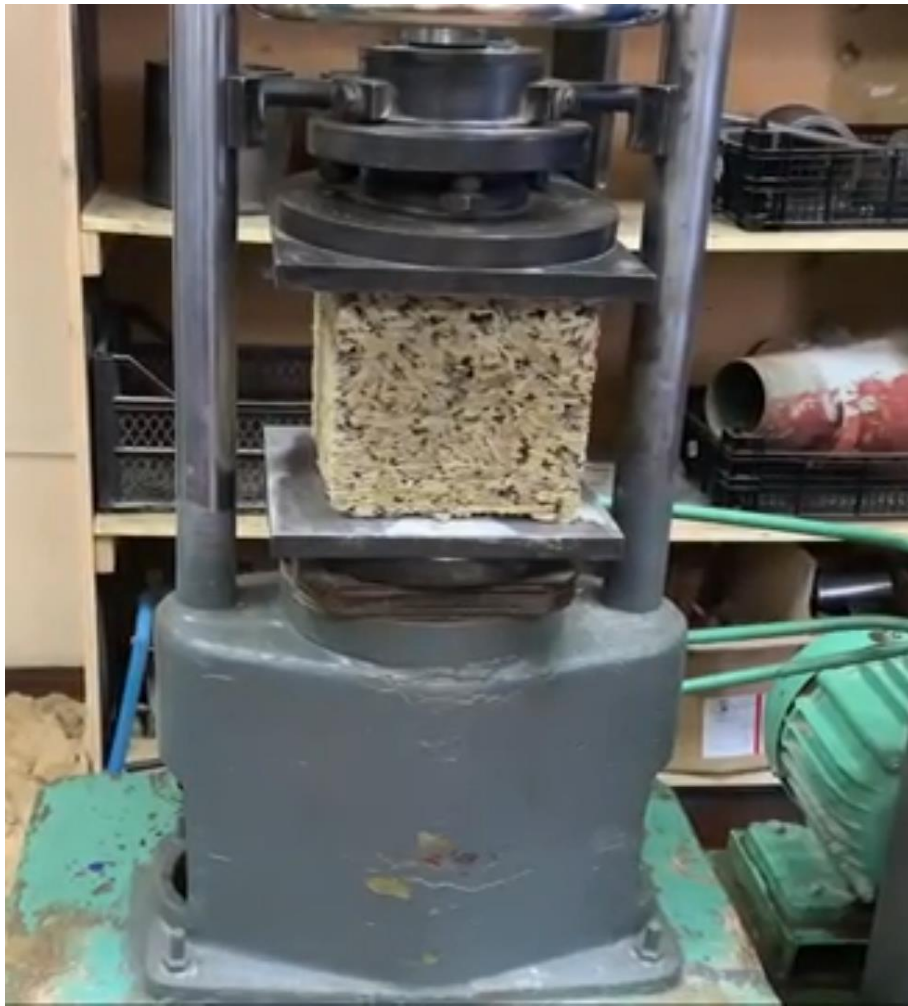
Рис. 4.19. Испытание образца куба размером с гранью 15 см на сжатие (вид образца до испытаний)
