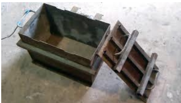
Рис. 2.2. Стальная форма для изготовления образцов арболита
