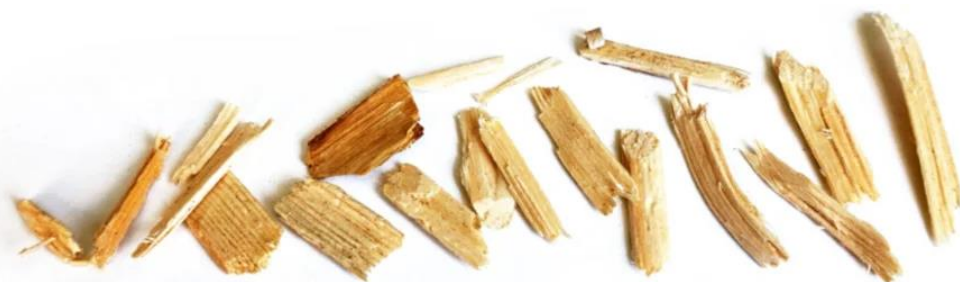
Рис. 1.3. Правильные формы щепы для изготовления арболита
