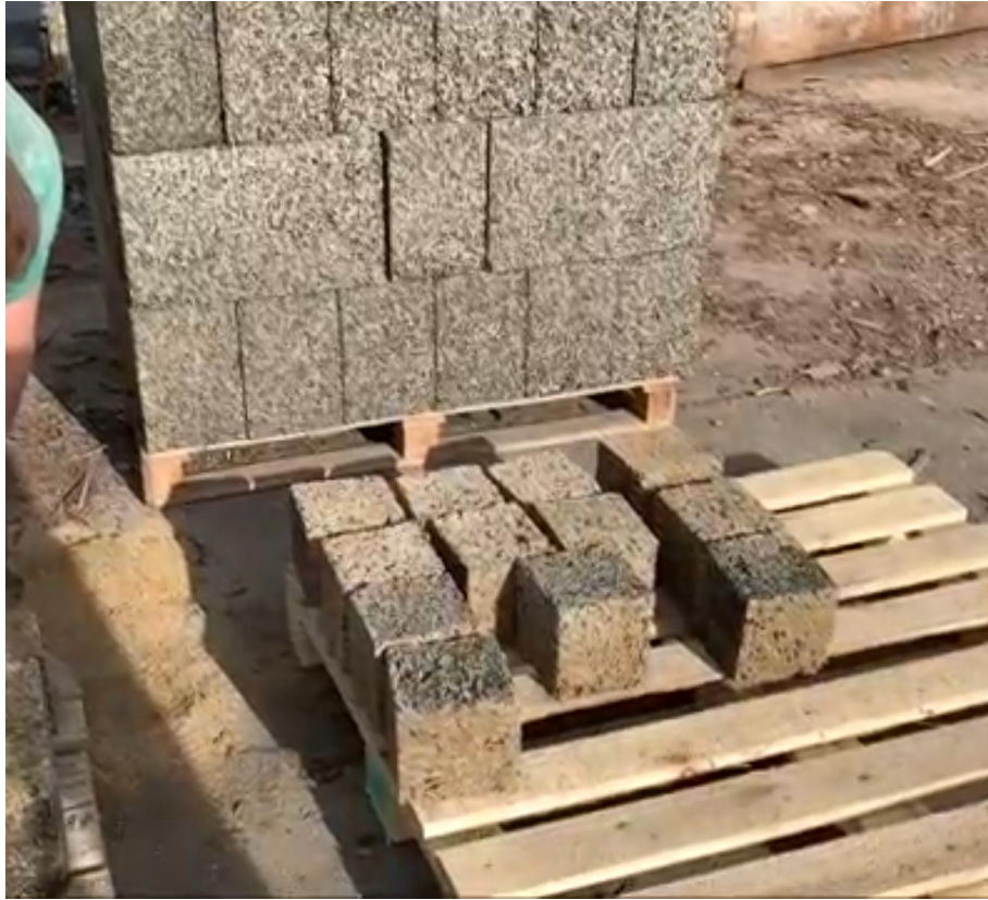
Рис. 4.18. Нарезанные блоки арболита для испытания на сжатие
