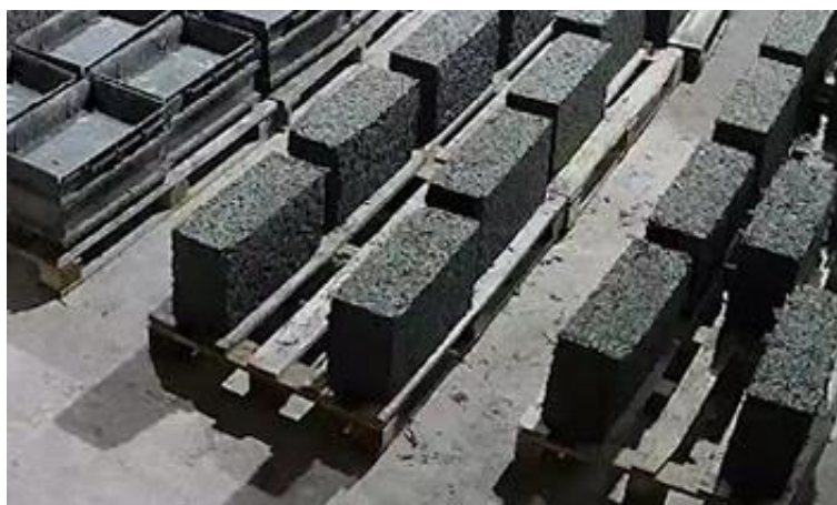
Рис. 2.3. Сушка блоков арболита на поддонах, после извлечения из стальной опалубки
