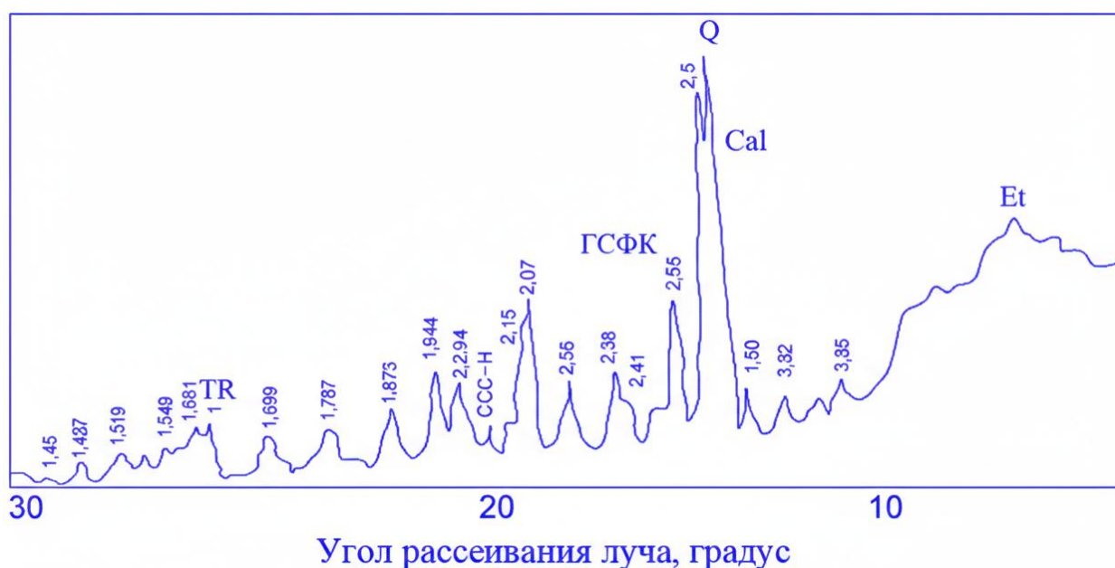
Рисунок 3.7 – Рентгенограмма легкобетонных образцов на основе стержней кукурузных початков на шлакощелочных вяжущих с добавками золы-уноса и 3% портландцемента. Условные обозначения фаз: TR — тоберморит; C–S–H — гидросиликаты кальция; ГСФК — гидросульфферрит кальция; Et — этtringит; Q — кварц ( \text{SiO}_2 ); Cal — кальцит ( \text{CaCO}_3 )
