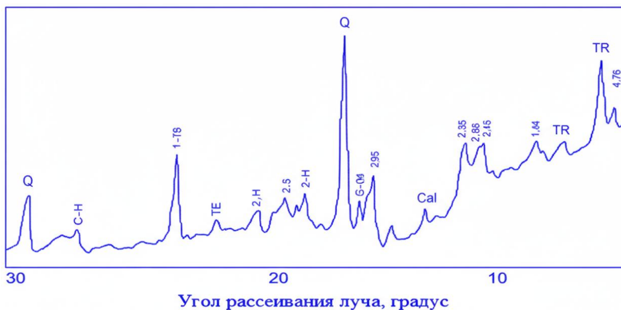
Рисунок 3.10. – Рентгенограмма легкобетонных образцов на основе стержней кукурузных початков шлакощелочных вяжущих композиции с добавками 7% портландцемента и золы-уноса. Условные обозначения фаз:
