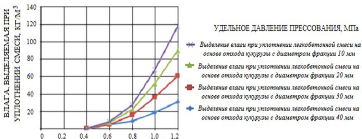
Рисунок 5.3. Влияние удельного давления прессования на влаговыделение легких бетонных смесей на основе стержней кукурузных початков
