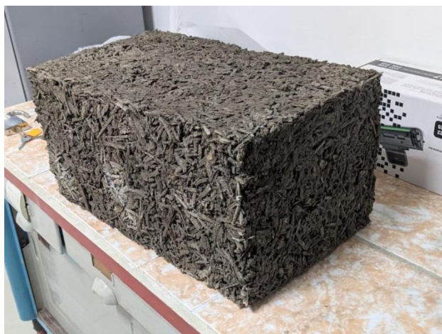
Рисунок 5.4. Шлакощелочной легковесный блок на основе стержней кукурузных початков
