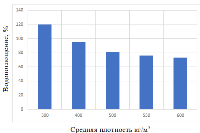
Рисунок 4.7. Зависимость водопоглощения от плотности шлакощелочного лёгкого бетона с кукурузным наполнителем
