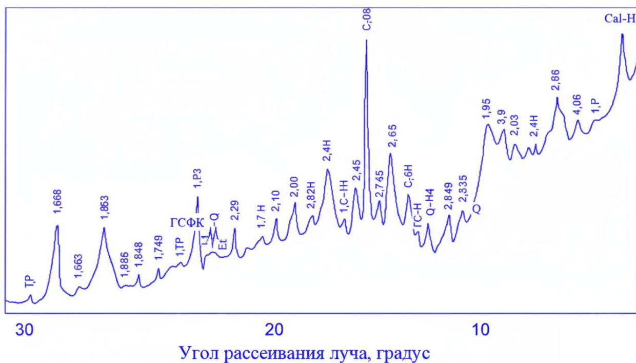
Рисунок 3.9– Рентгенограмма легкобетонных образцов на основе стержней кукурузных початков на шлакощелочных вяжущих без добавок. Условные обозначения фаз: TR — тоберморит; C–S–H — гидросиликаты кальция; ГСФК — гидросульфферрит кальция; Et — этtringит; Q — кварц ( \text{SiO}_2 ); Cal — кальцит ( \text{CaCO}_3 )
