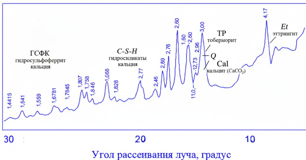
Рисунок 3.6 – Рентгенограмма легкобетонных образцов на основе стержней кукурузных початков на портландцементе с добавками золы-уноса и жидкого стекла. Условные обозначения фаз: TR — тоберморит; C–S–H — гидросиликаты кальция; ГСФК — гидросульфферрит кальция; Et — этtringит; Q — кварц ( \text{SiO}_2 ); Cal — кальцит ( \text{CaCO}_3 )
