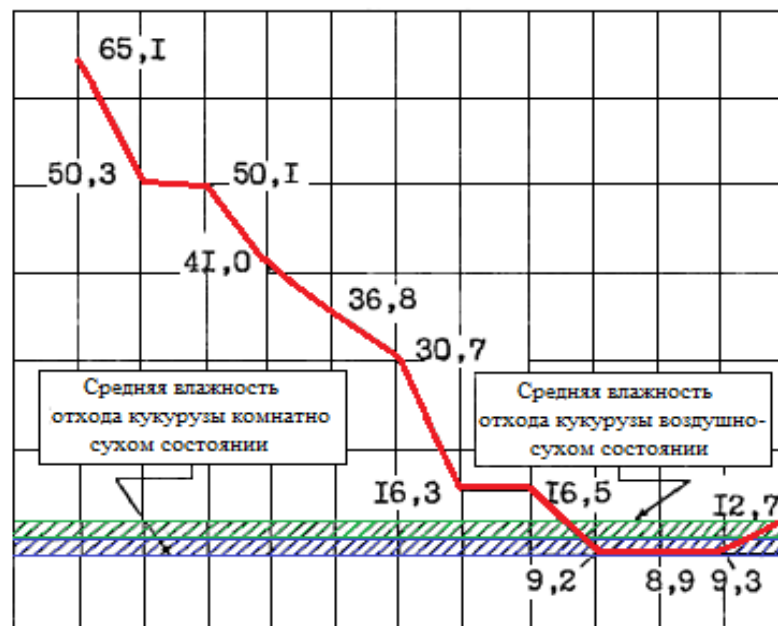
Рисунок 3.17. Изменение влажности стержней кукурузных початков в зависимости от времени и вида хранения
