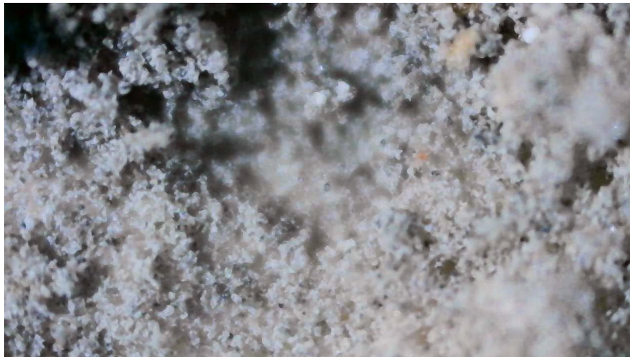
Рисунок 3.16. Микроструктура легкого бетона на основе стержней кукурузных початков со смешанными добавками (ССФСЗУП), состоящими из содосульфатной смеси, фосфорного шлака, золы-уноса и 7 % портландцемента от массы шлака
