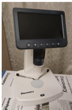
Рисунок 2.1. Микроскоп цифровой Artsan 512
