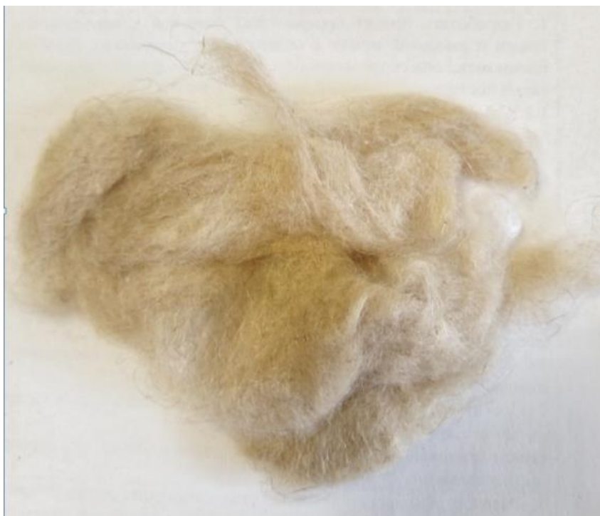
Рисунок 3.2. Льняные волокна на выходе из технологической линии для получения одиночных льняных волокон из котонина
