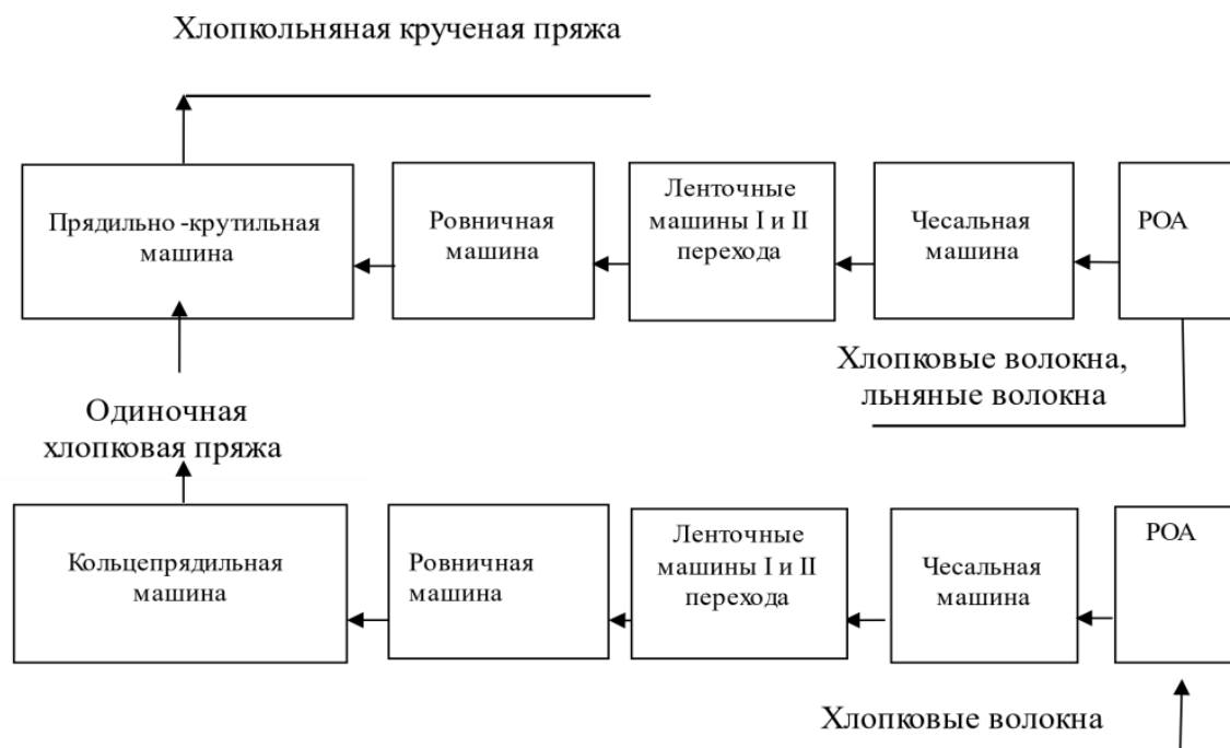
Рисунок 4.3. Схема технологического процесса получения хлопкольной крученой пряжи
