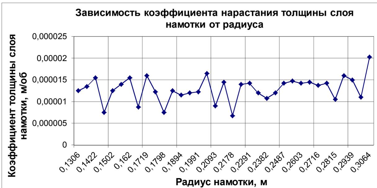
Рис. 4.1. Зависимость коэффициента нарастания толщины слоя намотки от радиуса
