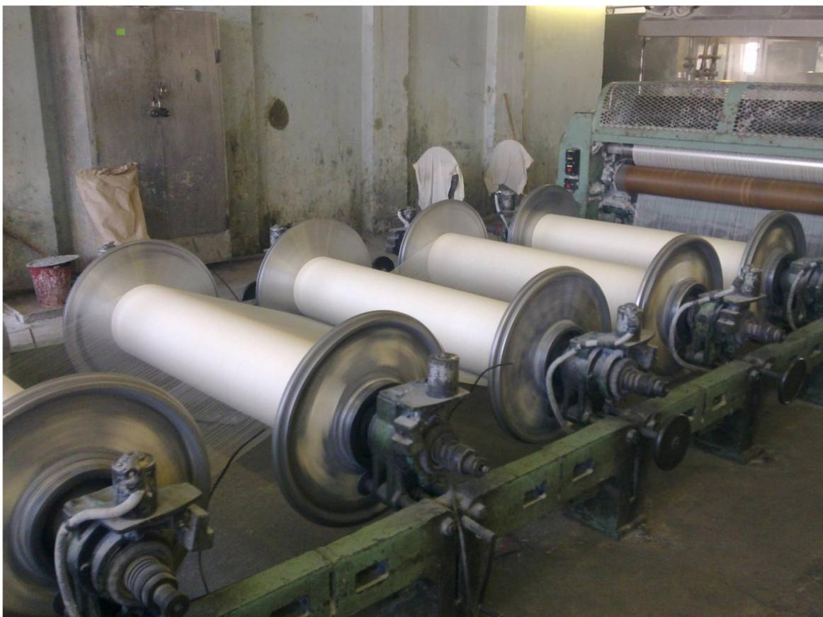
Рис. 4.9. Переработка экспериментальных партий сновальных валов на шлихтовальной машине
