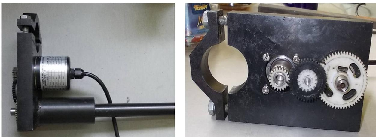
Рис. 3.3. Элементы крепления датчика радиуса – абсолютного энкодера
