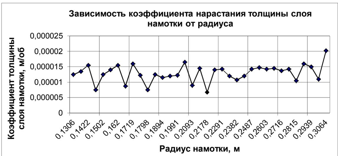
Рис. Б.3. Результаты обработки экспериментальных данных мониторинга вала № 3
