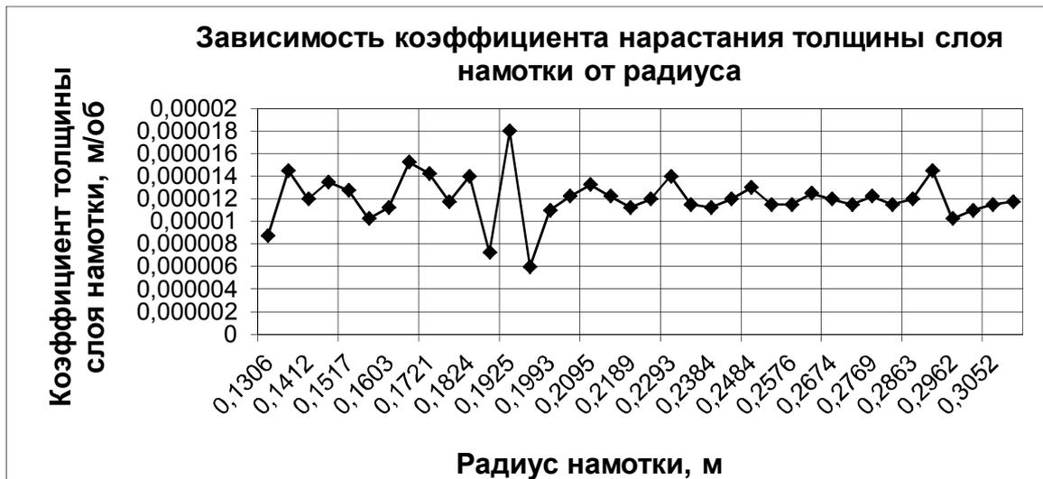
Рис. Б.1. Результаты обработки экспериментальных данных мониторинга вала № 1
