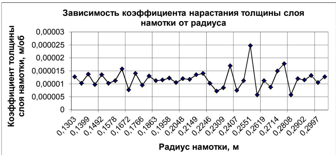
Рис. Б.8. Результаты обработки экспериментальных данных мониторинга вала № 8
