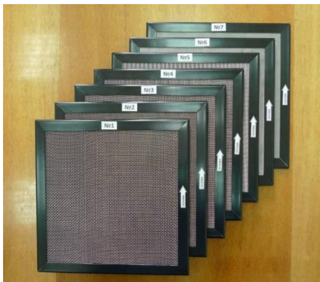
Рисунок 4.3 - Набор калибровочных стандартов по плотности нитей в тканых полотнах
