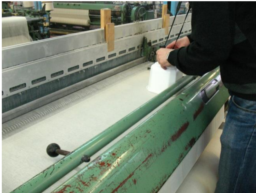
Рисунок 3.4 – Получение фото ткани на ткацких станках типа СТБ или АТПР
