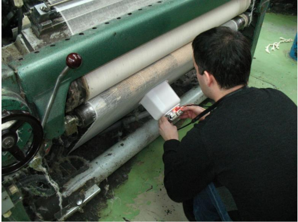
Рисунок 3.5 – Получение фото ткани на ткацких станках типа П или АП
