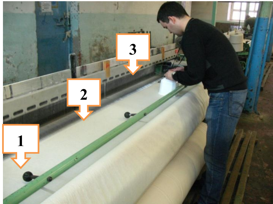
Рисунок 3.6 – Порядок получения снимков при однополотенной заправке станка
