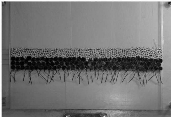
Рисунок 3.6. Установка для исследования миграции частиц в виброожигенном слое (процесс грохочения)
