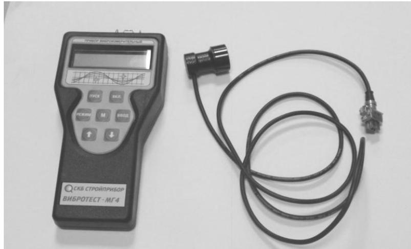
Рисунок 3.3. Вид прибора ВИБРОТЕСТ - МГ4
