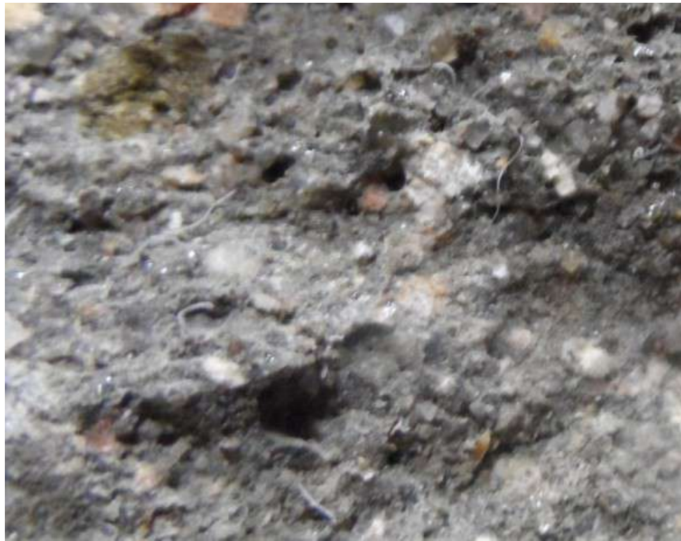
Рис. 3.4.8. - Микроструктура модифицированного мелкозернистого бетона с полипропиленовой фиброй (x50)
