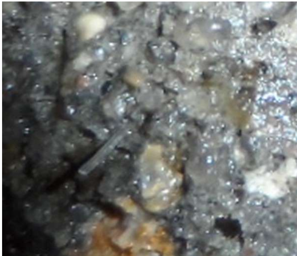
Рис. 3.4.9. - Микроструктура модифицированного мелкозернистого бетона с полипропиленовой фиброй (x500)
