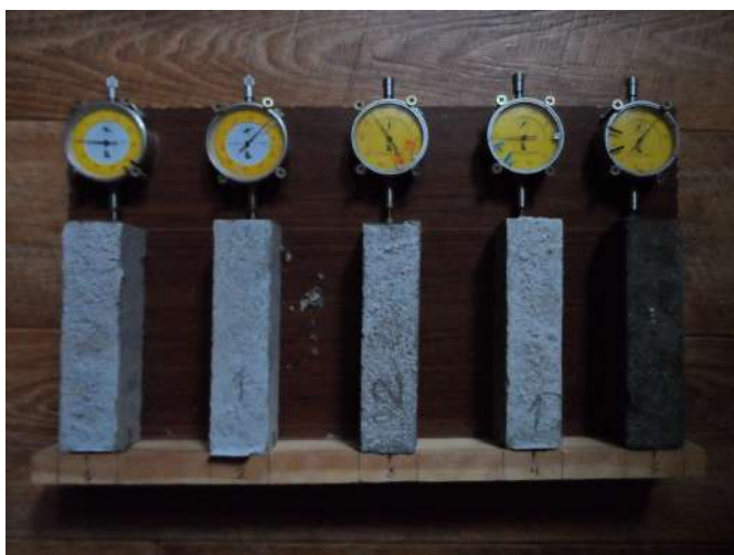
Рис. 2.2.6.2. - Устройство для измерений деформаций усадки.
