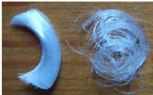
Рис. 5.2.1 - Полипропиленовая фибра до и после кипячения
