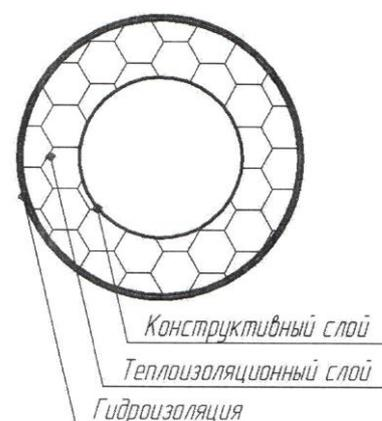
Рисунок 4 - Теплоизоляция трубопроводов
