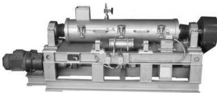
Рисунок 54 – Турболопастной смеситель (ТЛС)
