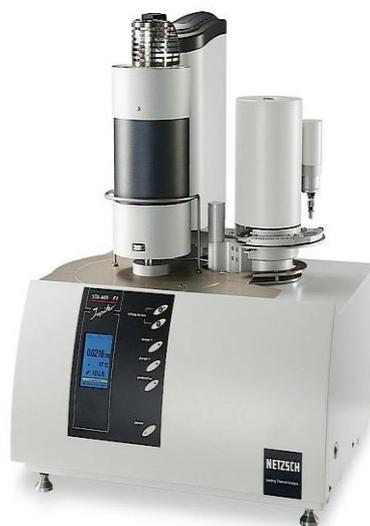
Рисунок 23 - Прибор синхронного термического анализа STA 449 F1 Jupiter
