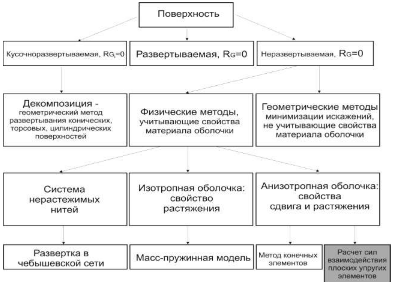
Рисунок 1.25 - Классификация способов разворачивания поверхности. Предложенный способ обозначен серым фоном.
