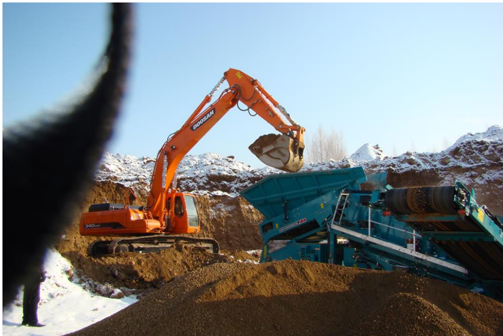
Рисунок 5.2. Мобильная сортировочная дизельная установка Maximus 516
