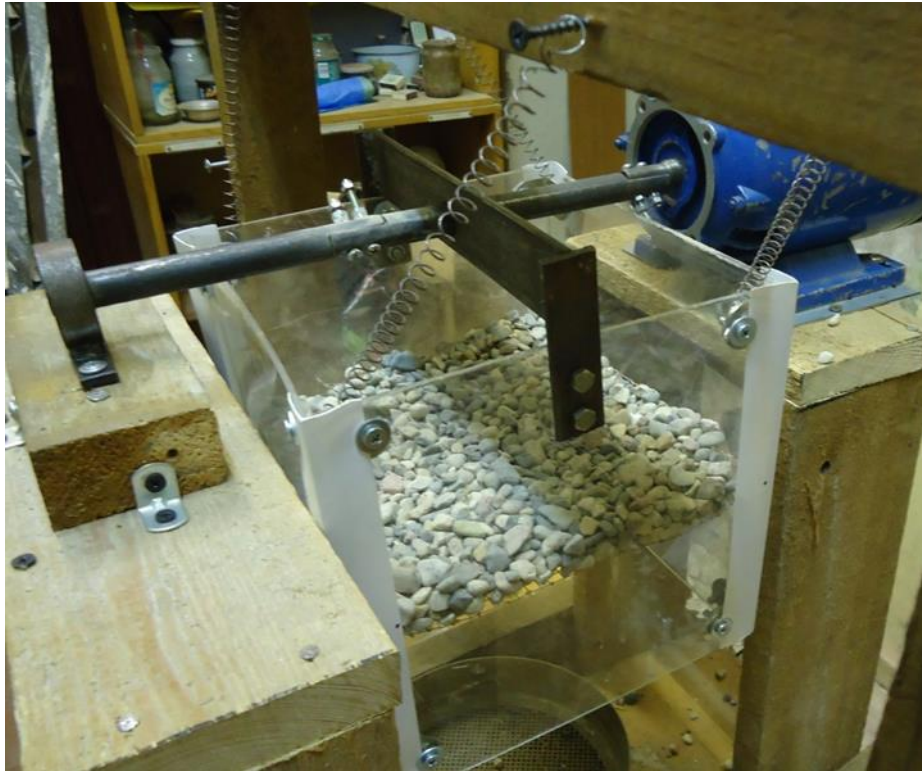
Рисунок 4.4. Вид установки по периодическому грохочению многокомпонентных смесей
