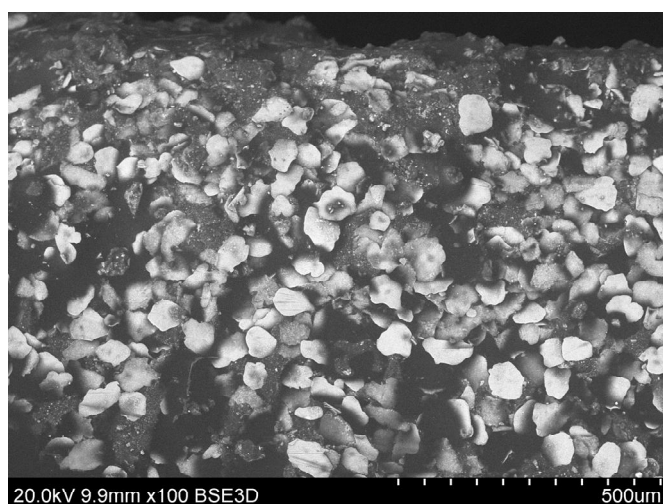
Рис. 2.10 Частички алюминиевого пигмента на поверхности покрытия
