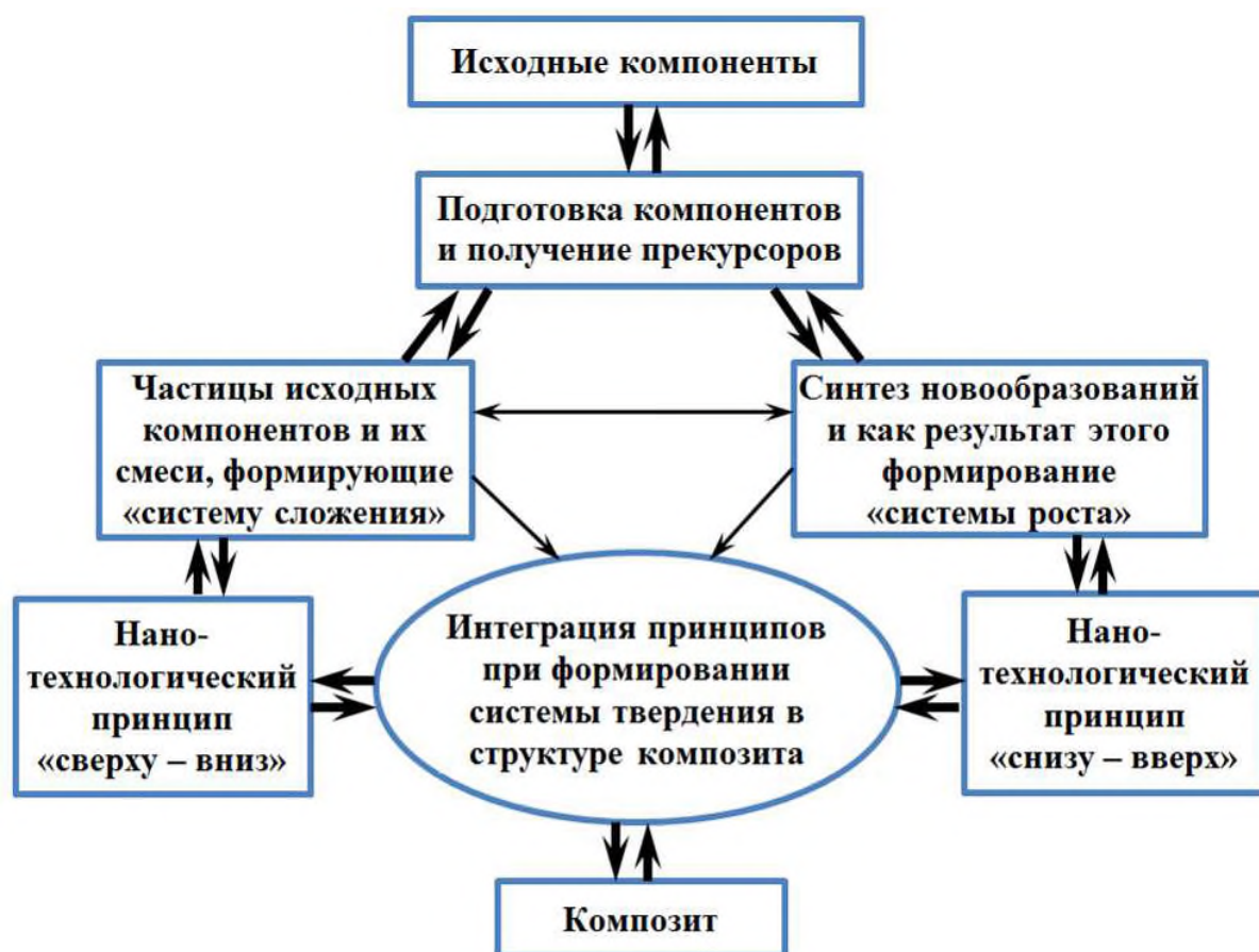
Рисунок 2.1 – Общая схема формирования структуры строительных композитов с позиций нанотехнологического подхода.
