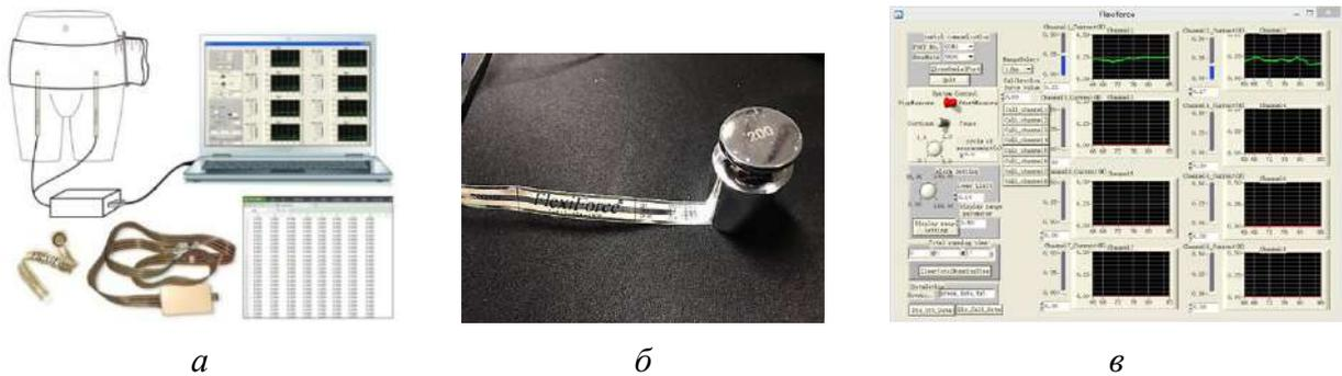
Рисунок 4.5 – Прибор для измерения давления: а– схема стенда; б– датчик давления; в– интерфейс системы сбора данных
