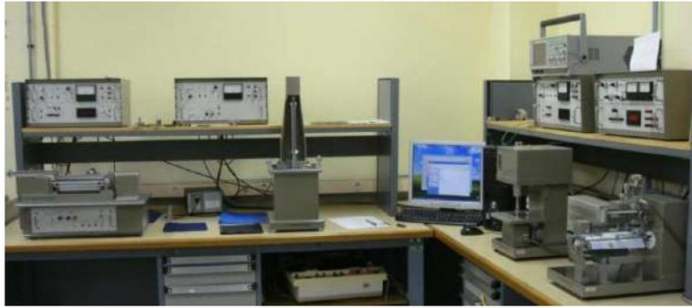
Рисунок 4.14 – Комплекс оборудования KES
