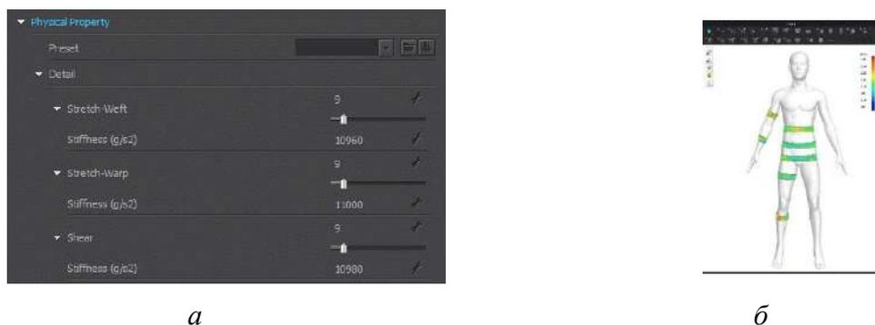
Рисунок 5.18 – Моделирование показателей свойств материалов для виртуального симулирования давления (а) и внешний вид аватара с участками симуляции виртуального давления  $P_V$  (б)
