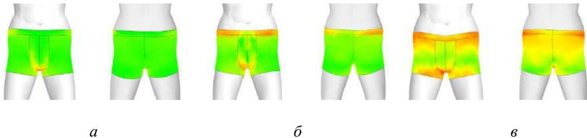
Рисунок 5.23 – Давление в системе «фигура  $M$  – боксеры I типа  $SM$ » при разных конструктивных прибавках, %:  $a - 0$ ,  $b - 10$ ,  $e - 19$
