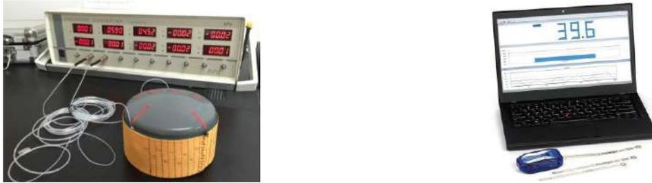
Рисунок 1.8 – Приборы для измерения давления
