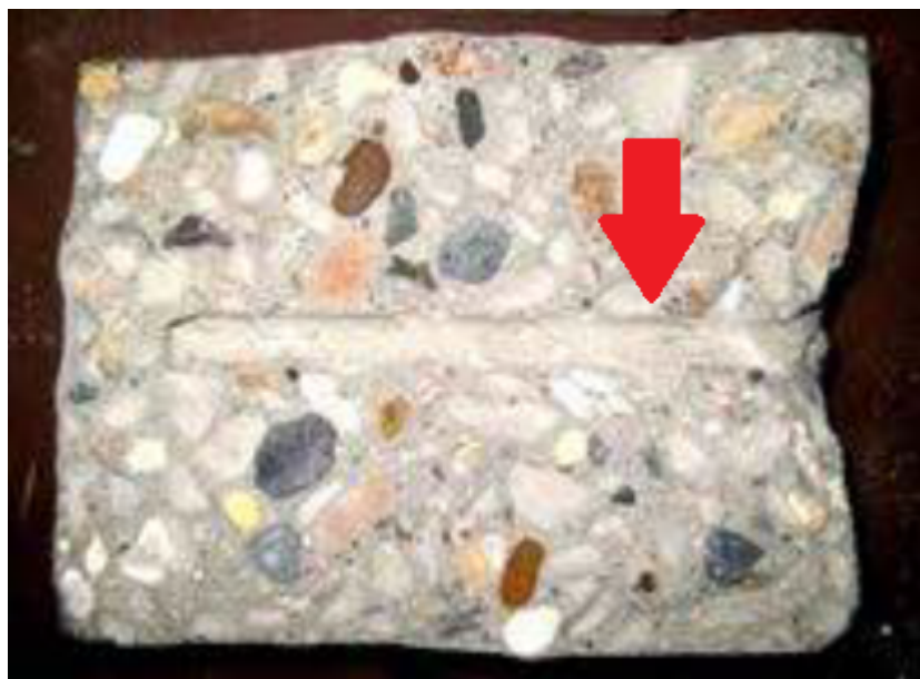
Рис. 4.2. Расколовшийся бетонные образец с очертаниями отверстия, занимаемого арматурой
