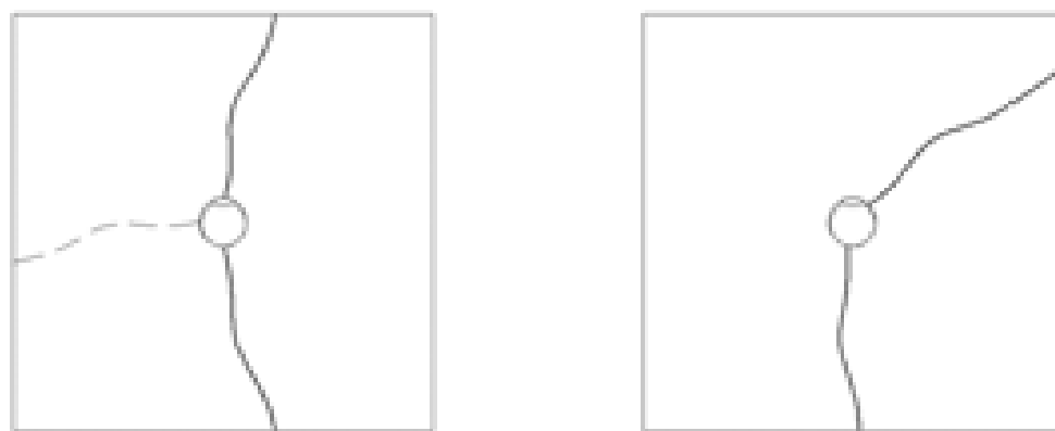
Рис. 4.1. Схемы разрушения бетонных кубиков при вырывании арматурных стержней
