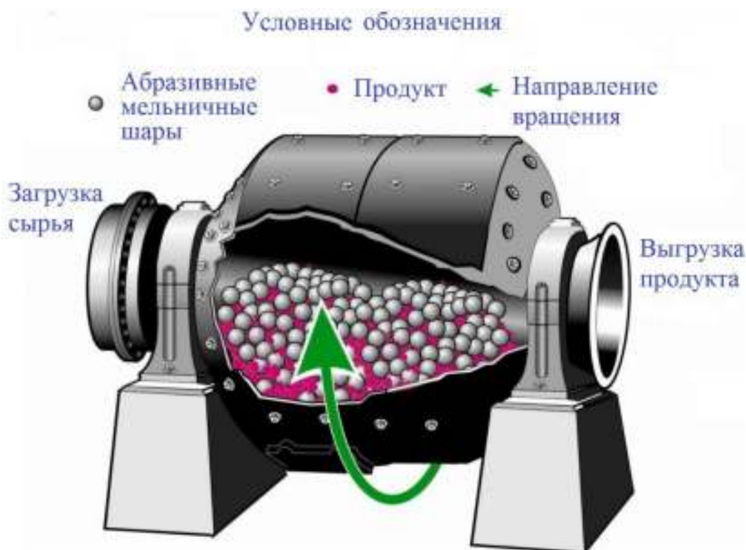
Рисунок 1.1 - Схема работы шаровой мельницы
