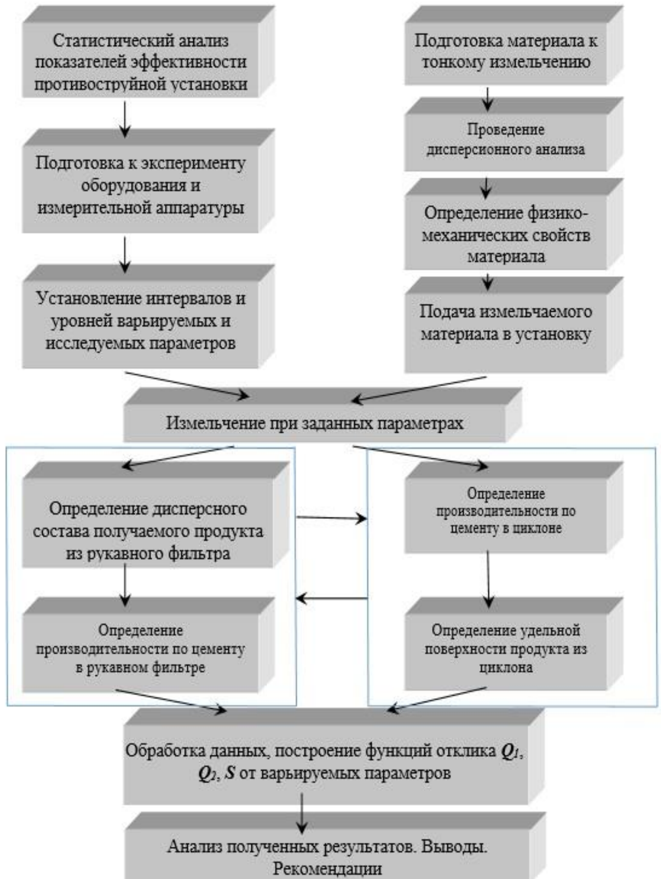
Рисунок 3.1 - Алгоритм проведения лабораторных и экспериментальных исследований процесса тонкого помола цемента в пневмоструйной установке
