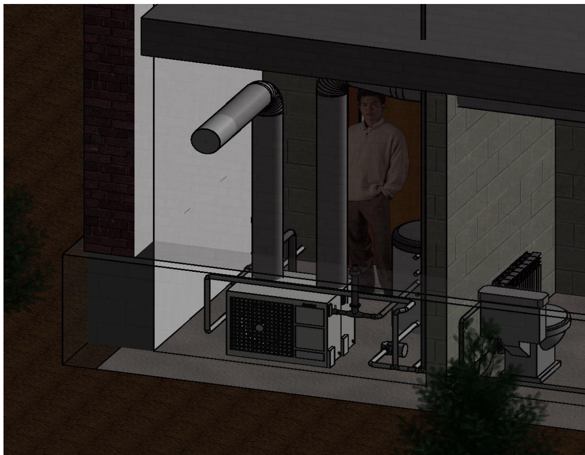
Рисунок 44 – 3D модель устройства ВТН внутри отапливаемого здания
