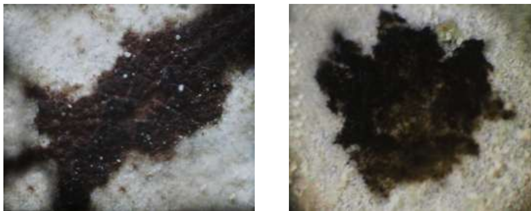
Рис. 4.9. Снимок (x60) поверхности экспериментального образца цементного камня, пораженного грибами рода A.niger
