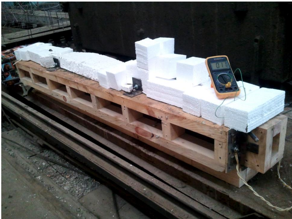
Рис. 5.4. Внешний вид установки при изготовлении железобетонной перемычки с применением ЭТО: а – после укладки и уплотнения бетона и в начальный момент ЭТО; б – в процессе ЭТО, когда поверхность бетона укрыта полиэтиленовой пленкой и пенопластом, а в проемах опалубки теплоизоляция отсутствует
