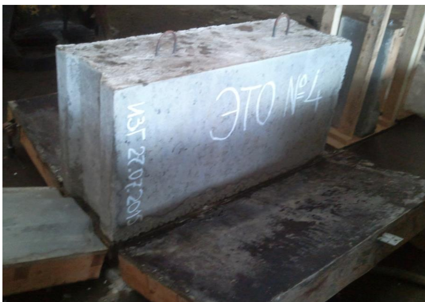
Рис. 5.3. Внешний вид готовых изделий – фундаментных блоков типа ФБС 9.4.6 (а) и ФБС 12.4.6 (б) после распалубки
