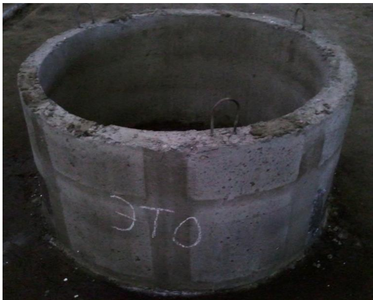
Рис. 5.6. Изготовление железобетонного колодезного кольца по безопалубочной технологии с применением ЭТО: а – внешний вид установки в ходе ЭТО; б – демонтаж системы эластичных электродов после завершения ЭТО и охлаждения изделия; в – внешний вид готового изделия
