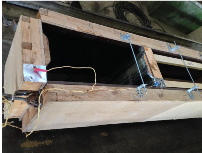
Рис. 4.3. Внешний вид опалубки для изготовления фундаментных блоков с использованием ЭТО электродным методом (опалубка находится в рабочем состоянии, т.е. подготовлена к укладке бетонной смеси для изготовления блока типа ФБС 9.4.6-Т)
