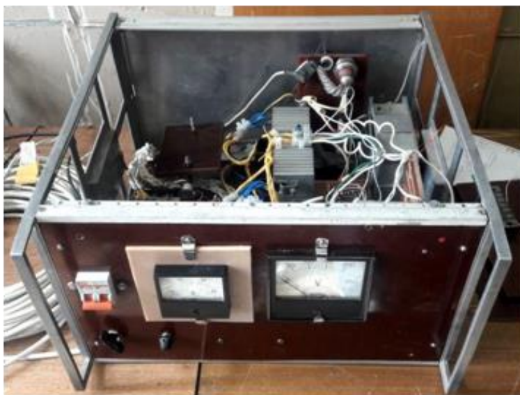
Рис. 4.13. Источники питания на основе полупроводникового преобразователя напряжения с использованием IGBT транзисторов: а) – мощностью 4 кВт; б) – мощностью 7 кВт
