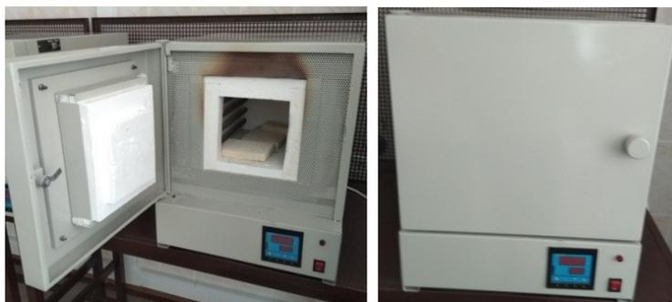
Рисунок 2.13 – Общий вид печи для проведения лабораторных исследований
