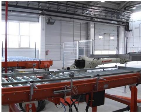
Рисунок 1.7 – Этап извлечение блоков пеностекла из форм
