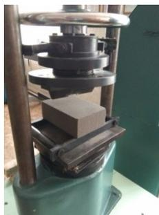
Рисунок 2.6 – Испытание на прочность на изгиб
