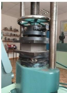
Рисунок 2.3 – Сжатие исследуемого образца
