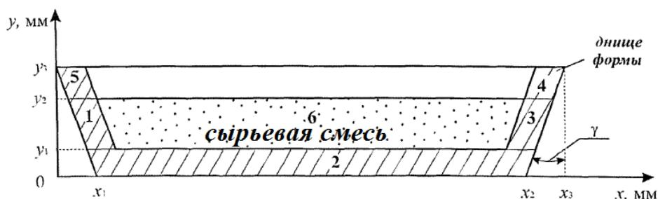
Рисунок 1.12 – Нагрев сырьевой смеси с учетом реальной геометрии формы
