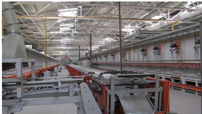
Рисунок 1.8 – Общий вид конвейерной ленты, необходимой для возвращения форм на этап разгрузки пенообразующей смеси
