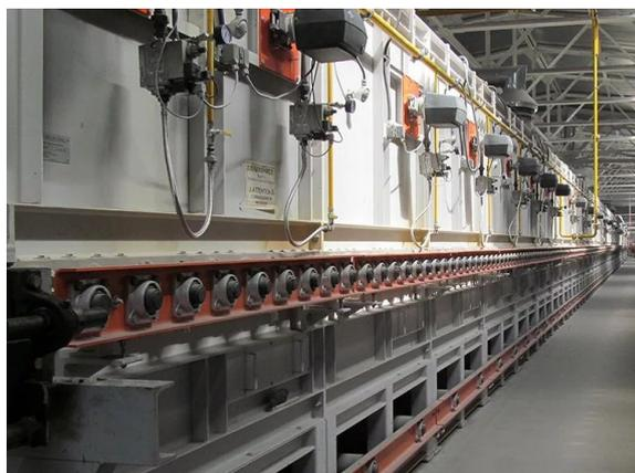
Рисунок 1.9 – Общий вид печи отжига
