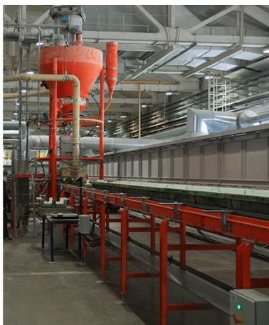
Рисунок 1.5 – Загрузка пенообразующей смеси в формы
