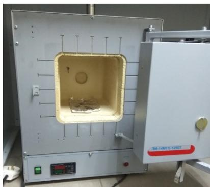
Рисунок 2.7 – Общий вид муфельной печи
