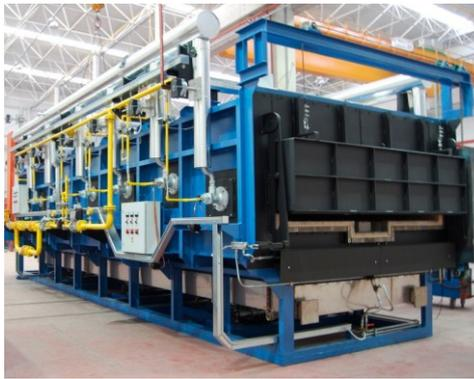
Рисунок 1.6 – Элемент печи нагрева, спекания, вспенивания и стабилизации
