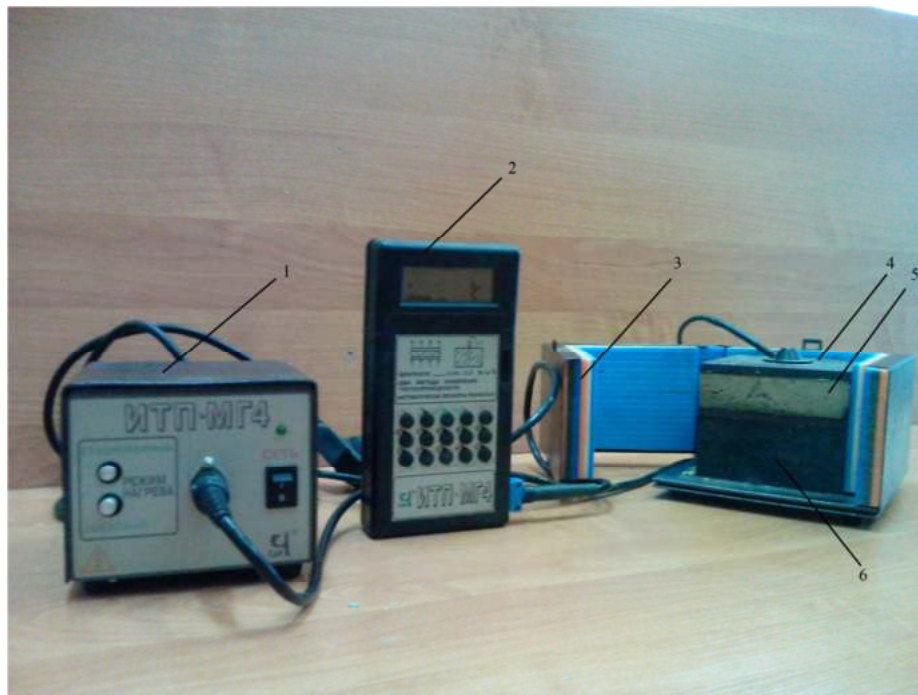
Рисунок 5.1 – Электронный измеритель теплопроводности ИТП–МГ4: 1 – блок управления; 2 – электронный блок; 3 – теплоизоляция; 4 – верхняя плита с датчиком температуры; 5 – образец; 6 – установка для нагрева
