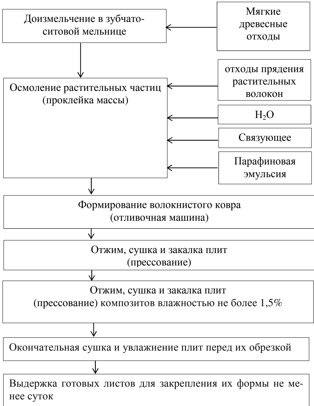
Рисунок 7.1 – Схема технологического процесса изготовления композитов
