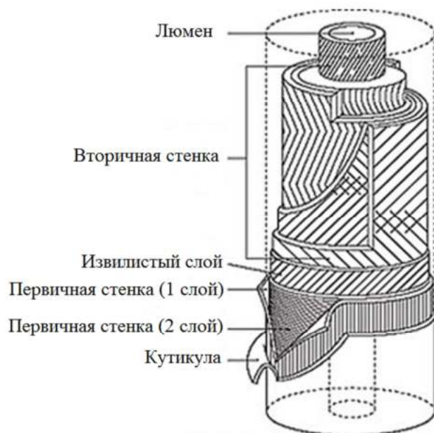
Рисунок 1.5 – Модель хлопкового волокна по современным представлениям
