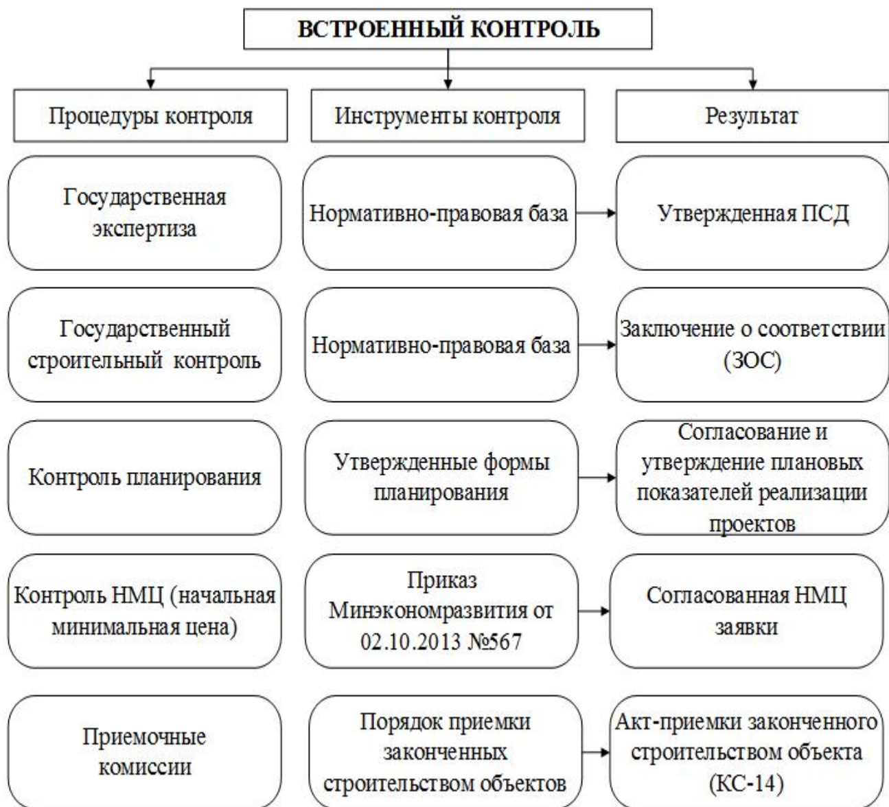
Рисунок 2.5 – Состав и структура встроенного контроля
