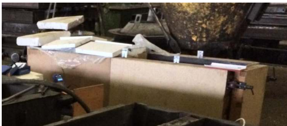
Рис. 5.2. Внешний вид опалубки в процессе ЭТО при изготовлении фундаментных блоков типа ФБС 12.4.6: а – в начальный момент; б – в последующее время
