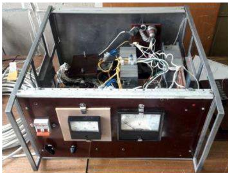
Рис. 4.13. Источники питания на основе полупроводникового преобразователя напряжения с использованием IGBT транзисторов: а) – мощностью 4 кВт; б) – мощностью 7 кВт
