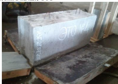
Изделие после распалубки
