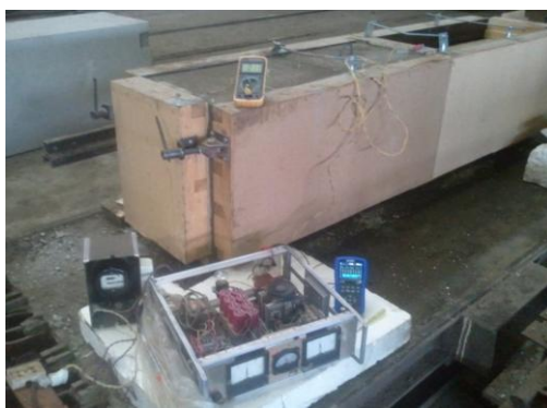
Внешний вид установки в начале ЭТО
