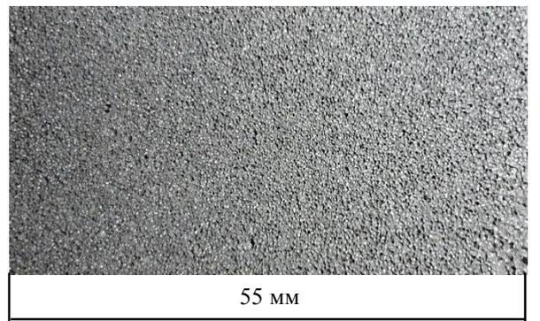
Фото шестого образца ( $\lambda = 0,079$  Вт/(мК);  $\rho = 190$  кг/м<sup>3</sup>;  $W^n = 9$  %;  $d_{\max} = 0,3$  мм)
