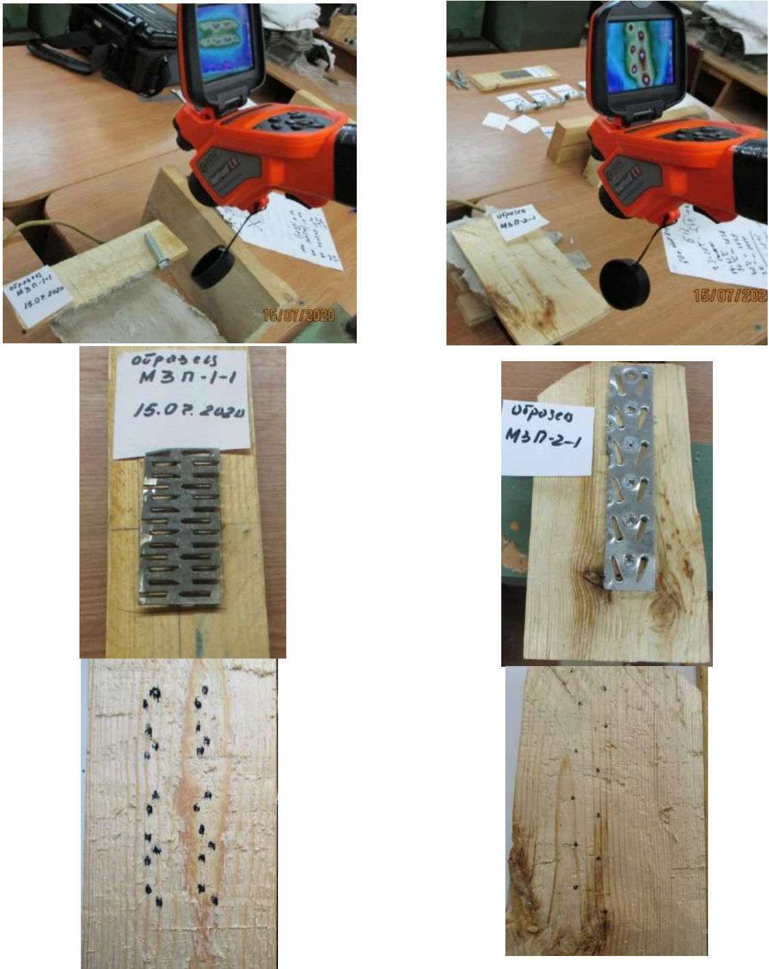
Рисунок 5.13. Внешний вид экспериментальной установки, экспериментальных образцов для изучения динамики температурных полей в нагельных соединениях на МЗП
