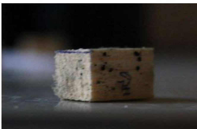
Рис. 5.3 Внешний вид образца из сосны после выдержки в атмосфере раствора серной кислоты с концентрацией 1 %
