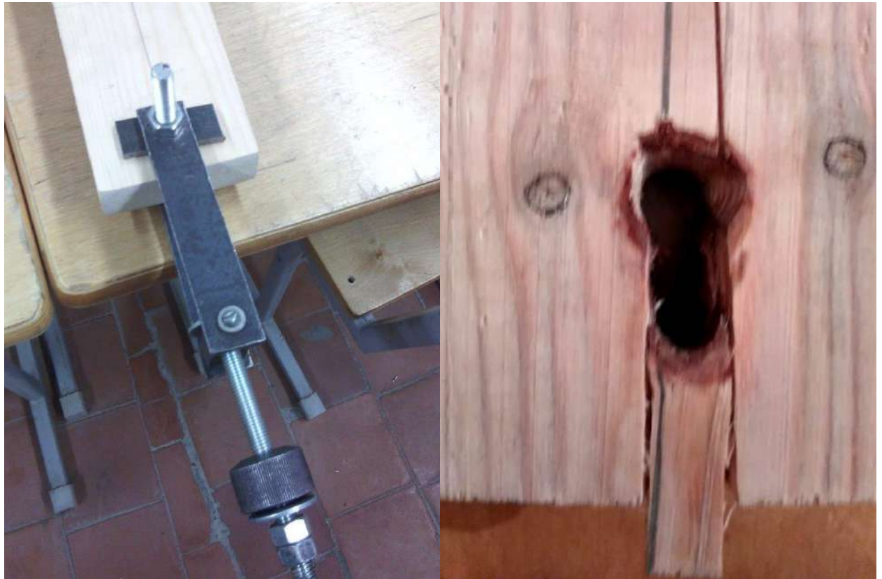
Рисунок 5.26. Внешний вид образца болтового нагельного соединения в собранном виде перед установкой в климатическую камеру для проведения испытаний (а) и характер разрушения этого образца в ходе эксперимента (б)
