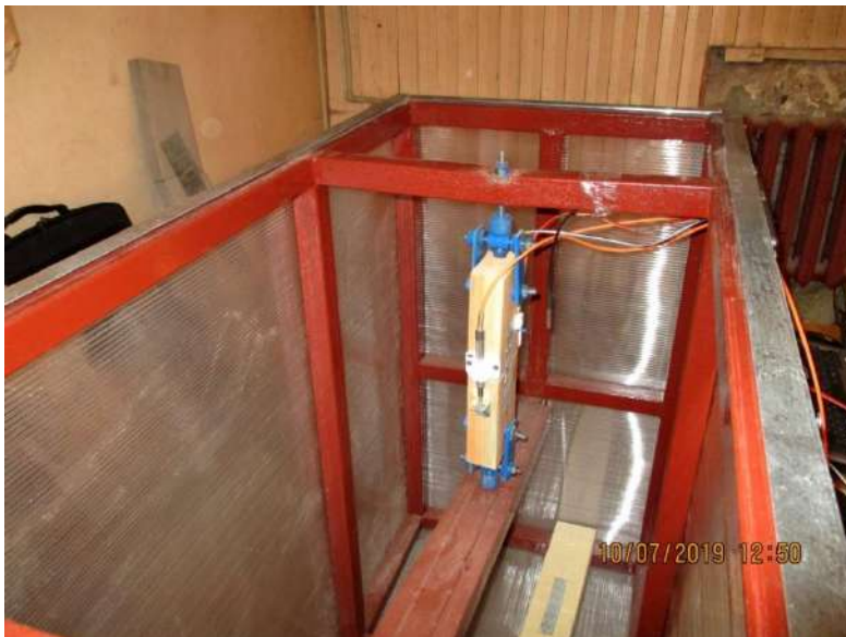
Рисунок 5.23. Внешний вид установленного в рабочее положение образца нагельного соединения на МЗП с расположенными на нем датчиками деформации перед началом эксперимента
