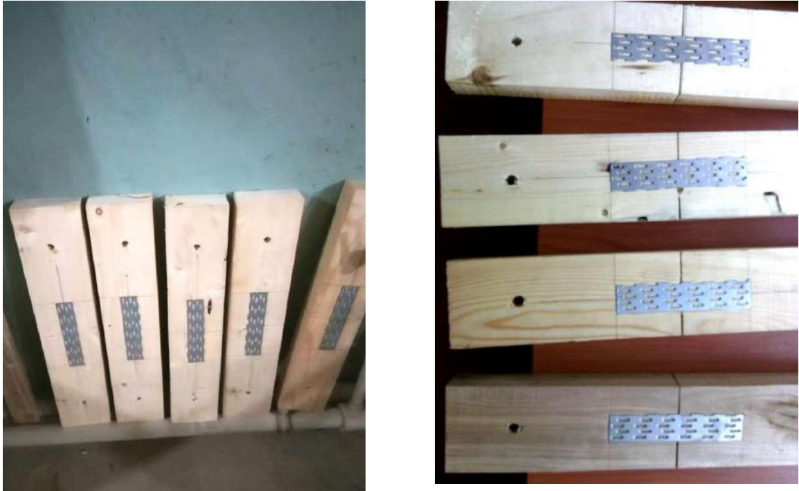
Рисунок 5.22. Образцы нагельных соединений на МЗП типа МЗП-1,0, подготовленные для проведения экспериментов
