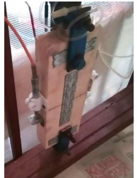
Рисунок 5.23. Внешний вид установленного в рабочее положение образца нагельного соединения на МЗП с расположенными на нем датчиками деформации перед началом эксперимента
