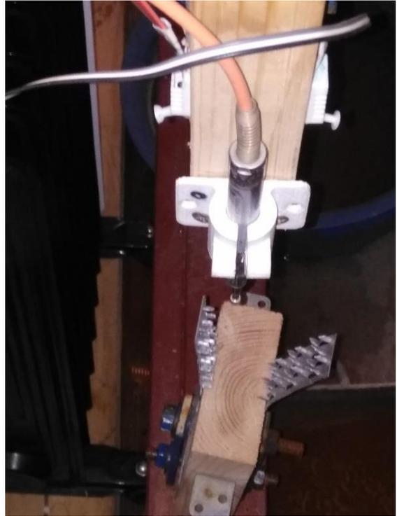
Рисунок 10. Нагельное соединение на МЗП, разрушенное в ходе экспериментов
