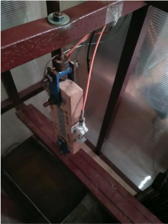
Рисунок 9. Внешний вид образца нагельного соединения на МЗП, установленного для испытаний внутри климатической камеры с датчиками деформаций
