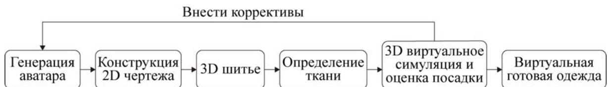
Рисунок 1.33 - Процесс создания виртуальной одежды и оценки посадки
