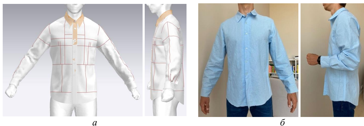
Рис.9 - Цифровой двойник сорочки для Сергея К., полученный по кастомизированным чертежам и реальный кастомизированный образец сорочки
