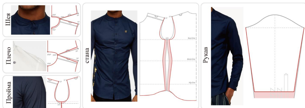
Рис.3 - Фрагмент матрицы для участков горловины, плечевого пояса, стана, проймы, рукава "индикаторы посадки - конструктивные параметры"
