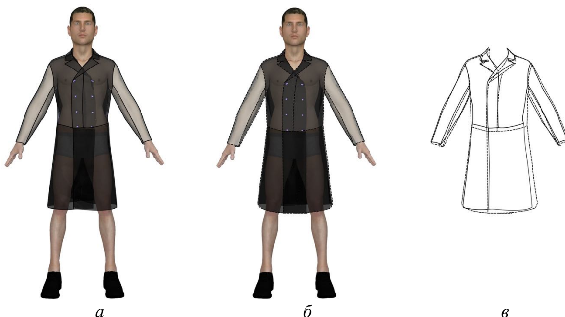
Рисунок 3.12 - Цифровые двойники пальто, сгенерированные из РВ1: а - с использованием конструктивных прибавок, выражение (3.5); б - для исторической фигуры и с учетом, выражение (3.4); в - для современной фигуры и их совмещенные абрисы
