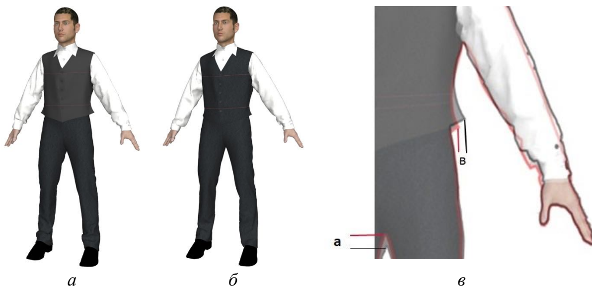
Рисунок 3.7 - Виртуальные двойники исторической системы, полученные путем формирования пакета материалов одежды путем: а - простого суммирования толщин исходных материалов; б - добавления между ними воздушных зазоров; в - фрагмент совмещенных фронтальных контуров. Красным цветом выделен двойник на ( б )
