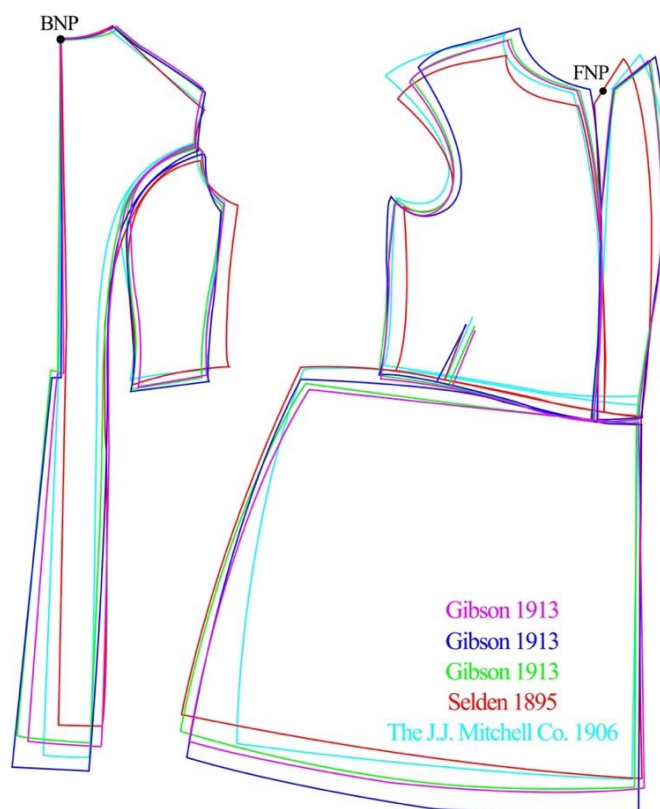
Рисунок 3.8 - Совмещенные схемы чертежей деталей мужских пальто (время создания чертежей указано на деталях юбок)
