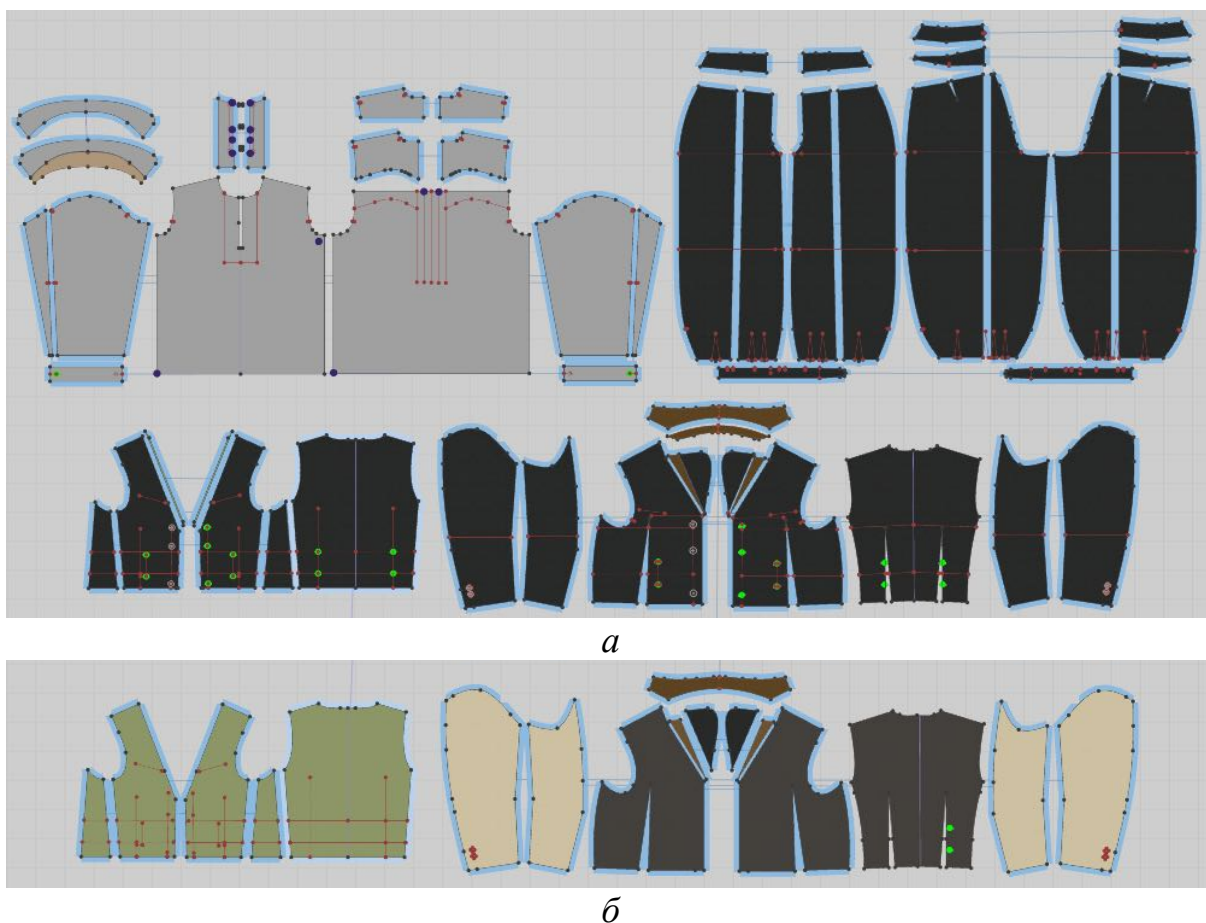
Рисунок 5.6 - Чертеж четырех предметов одежды униформы: а - оболочка рубашек, брюк, жилета и пиджака; б - подкладка жилета и пиджака
