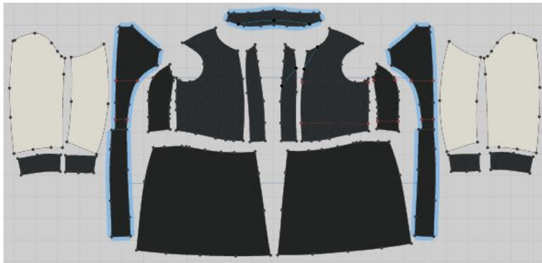
Рисунок 3.3 - Скриншот полного комплекта чертежей деталей пальто в САПР: a - детали из ткани верха; б - детали из подкладки; в - прокладочные детали
