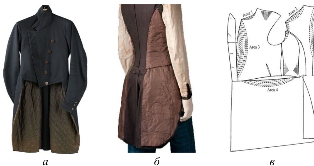
Рисунок 1.20 - Схемы обработки фрака в конце XIX века: а - вид с лицевой стороны [38]; б - вид с изнаночной стороны [39]; в - места влажно-тепловой обработки [13]
