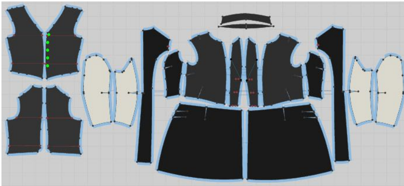
Рисунок 5.12 - Чертеж пяти предметов одежды ИКК: a - сорочка, нижние брюки, брюки, жилет и сюртук; б - подкладка жилета и сюртука; в - подкладки сюртука
