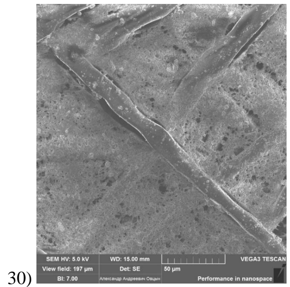
Рис. 4.2. Снимки поверхности мембран после проведения испытания на проницаемость
