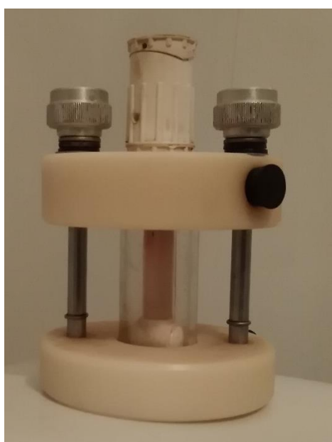
Рис. 2.1. Ячейка для исследования проницаемости мембран
