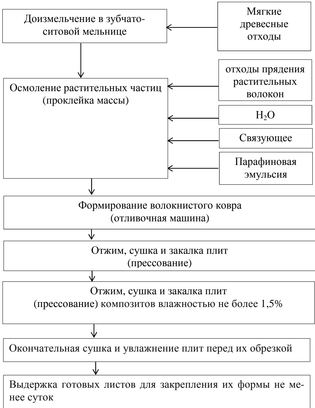
Рисунок 7.1 – Схема технологического процесса изготовления композитов
