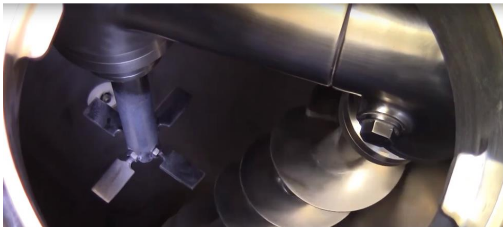
Рисунок 1.4. Рабочая камера шнекового смесителя Nauta®
