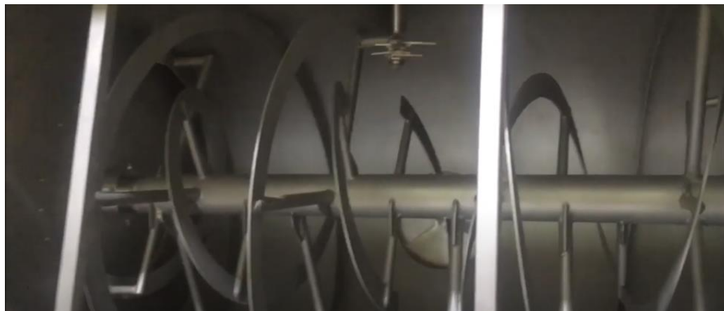
Рисунок 1.5. Рабочая камера шнекового смесителя
