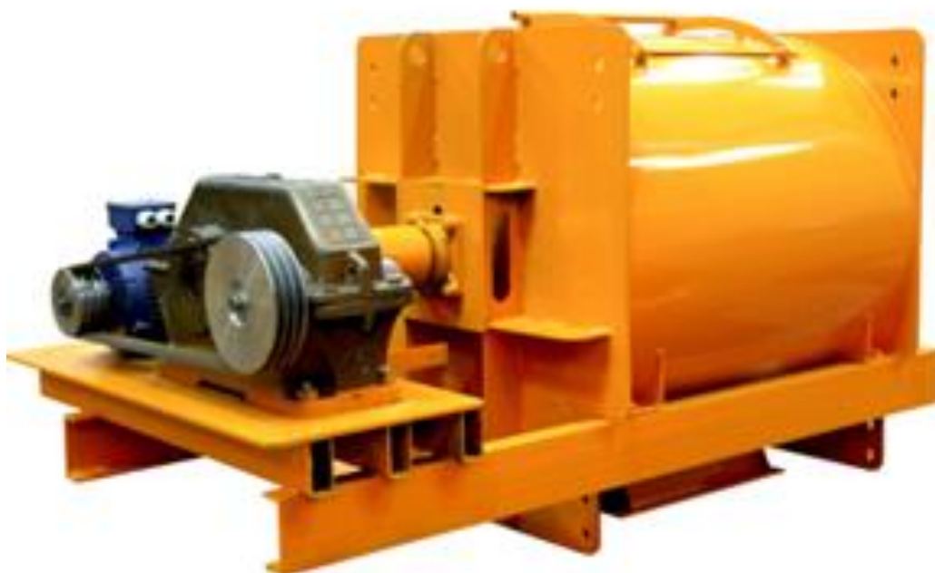
Рисунок 1.4. Лопастной смеситель периодического действия серии «СС-500» компании «МЕТЕМ»
