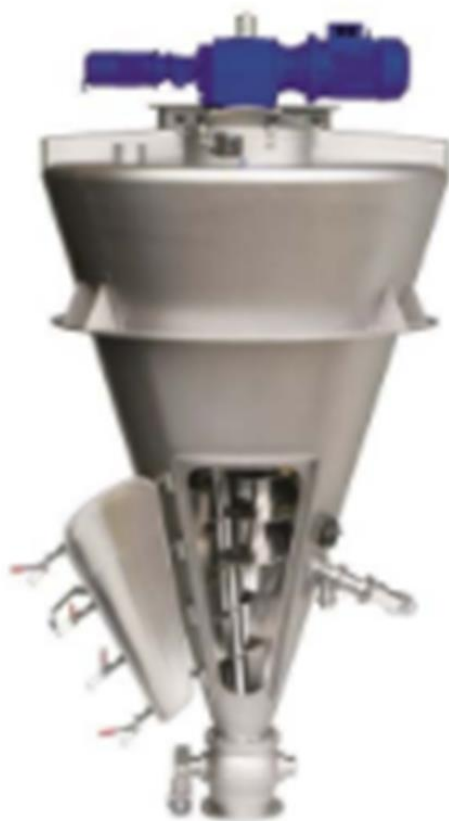
Рисунок 1.3. Конический шнековый смеситель фирмы Nauta®
