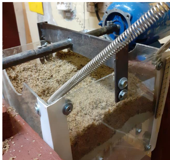
Рисунок 3.20. Начальное положение сыпучей смеси перед процессом смешивания
