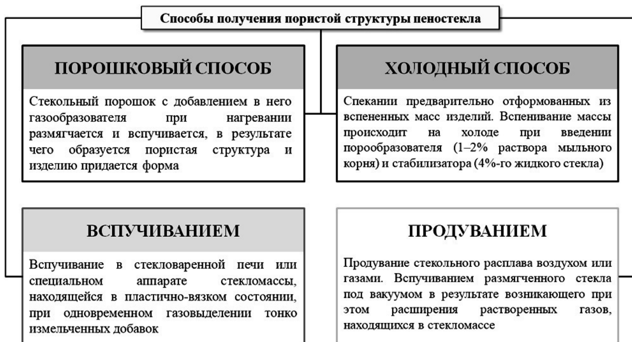
Рисунок 1.4 – Способы получения пористой структуры пеностекла
